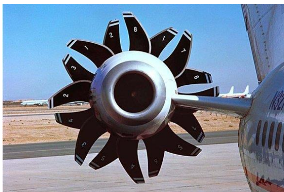
Obr. 2.2 Čelní pohled na dmychadlo motoru GE-36 s protiběžnými rotory [6]
