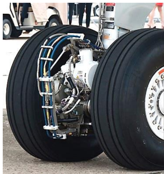
Obr. 3.6 EGTS na hlavní podvozkové noze Airbusu 320 [8]
