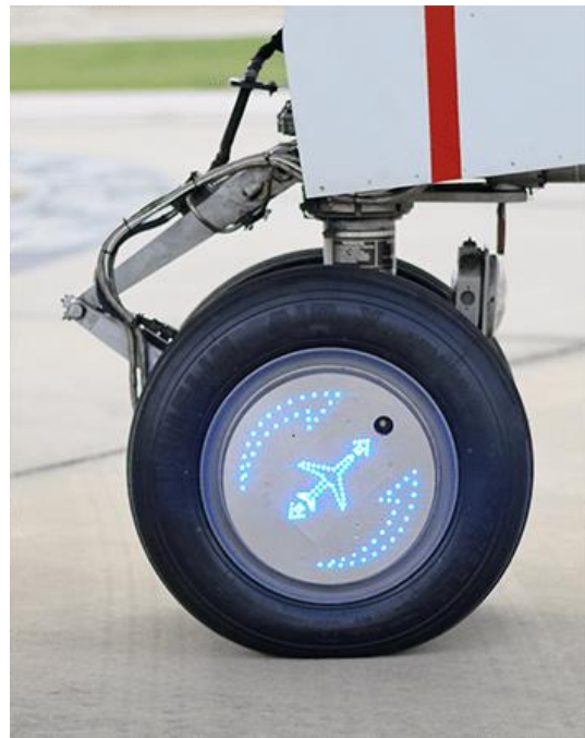
Obr. 3.4 Poháněný předový podvozek (WheelTug) [28]
