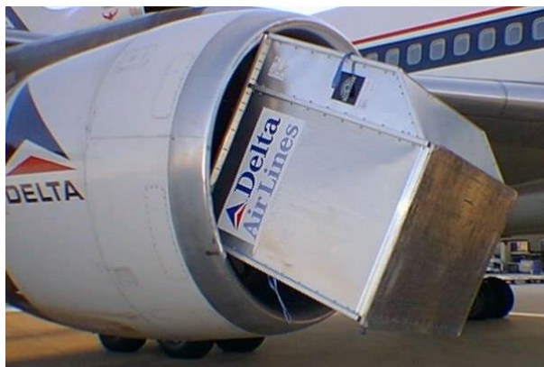
Obr. 2.1 Motor letounu po nasátí cizího objektu (FOD) [33]
