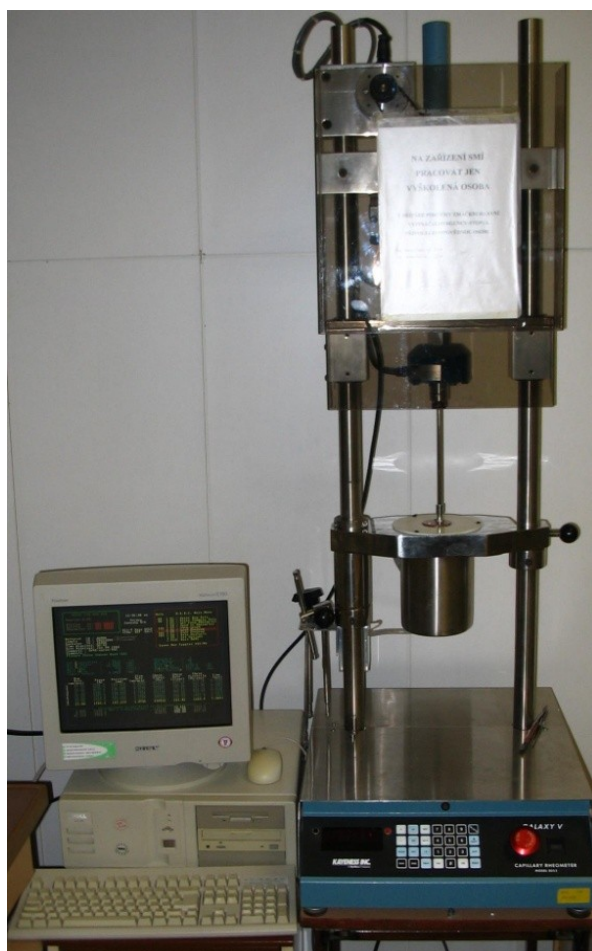
Obr. 4.3 Kapilární reometr Kayeness Galaxy V
