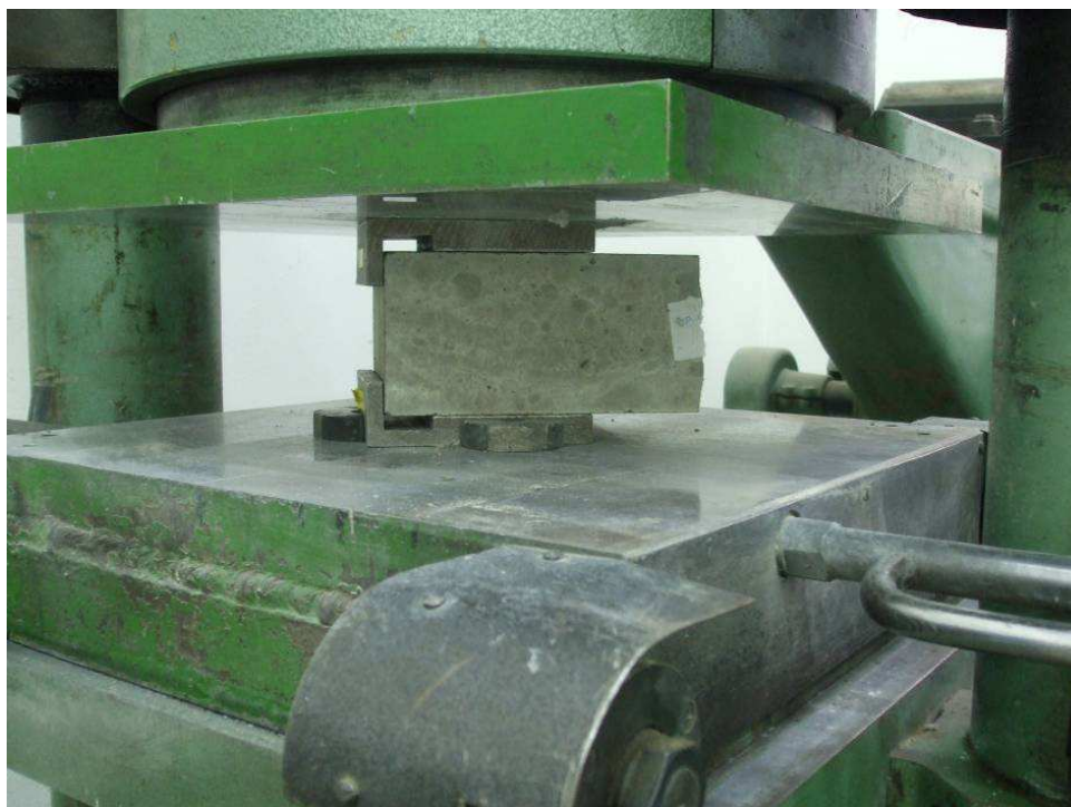
Obr. č. 14. Fotografie zkoušky pevnosti v tlaku na úlomcích
