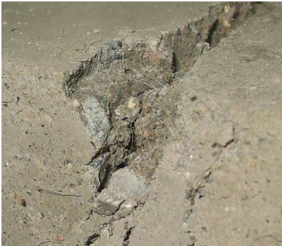
Obr. č. 17. Detail lomu po zkoušce pevnosti v tahu za ohybu
