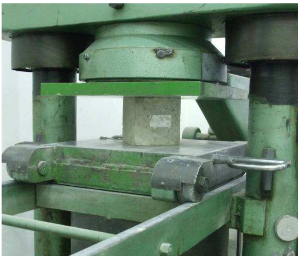
Obr. č. 15. Fotografie zkoušky pevnosti v tlaku na kostkách
