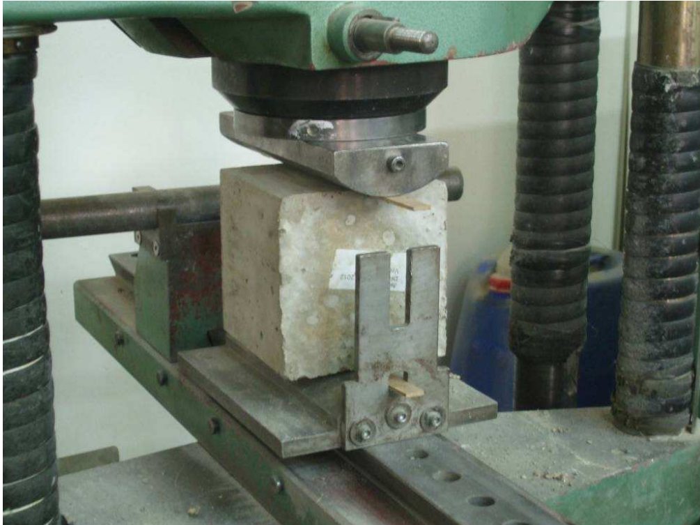
Obr. č. 19. Fotografie zkoušky pevnosti v příčném tahu na kostkách
