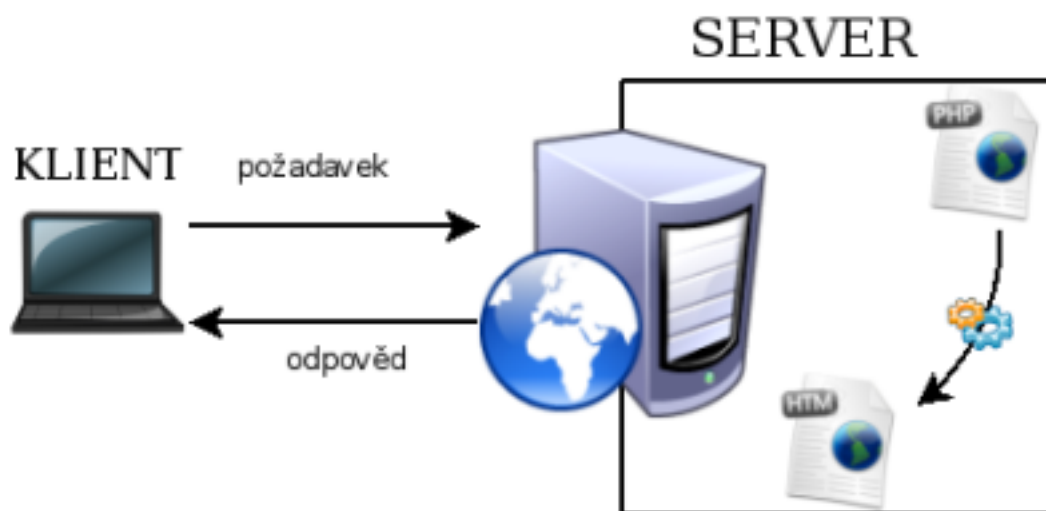
Obr. 1.4: Komunikace klient-server s PHP na serveru
