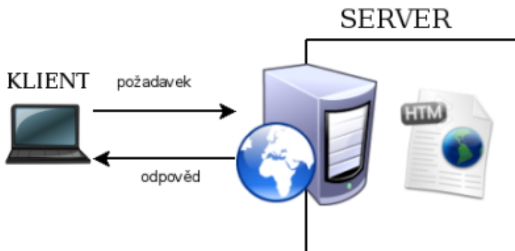
Obr. 1.3: Komunikace klient-server bez PHP na serveru
