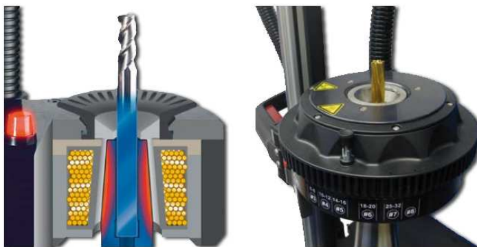
Obr. 2.10 System tepelného upínání [28].
