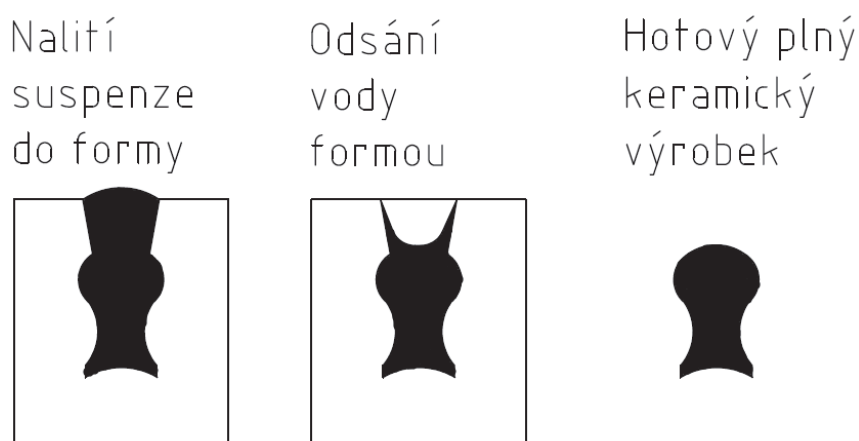
Obr. 1.9 Výroba plné součásti suspenzním litím [1].
