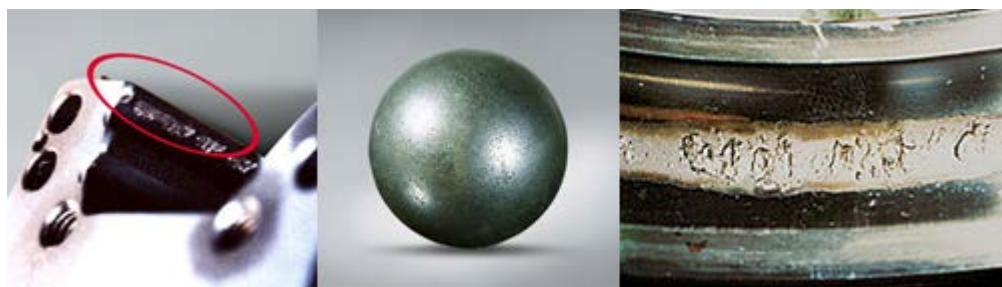
Obr. 18 Součástky opotřebené pittingem a flakingem – vlevo vedení, uprostřed kulička, vpravo vnější kroužek ložiska [6] [7] [5]
