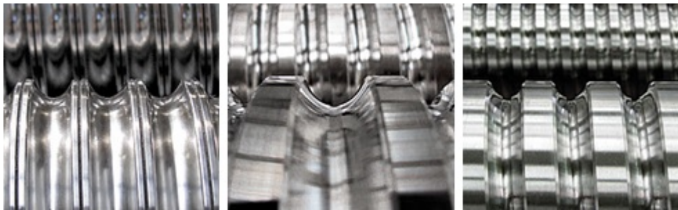
Obr. 4 Broušený závít (vlevo), okružovaný závít (uprostřed), válcovaný závít (vpravo) [25]
