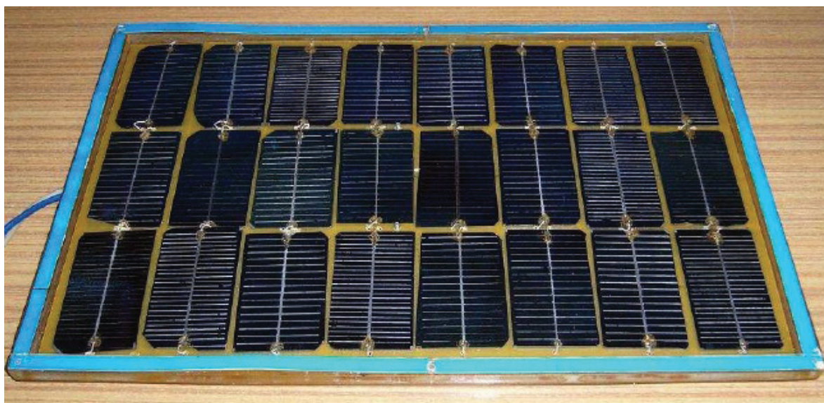
Obr. 7.5: Reálný fotovoltaický panel (24 sériově zapojených článků)
