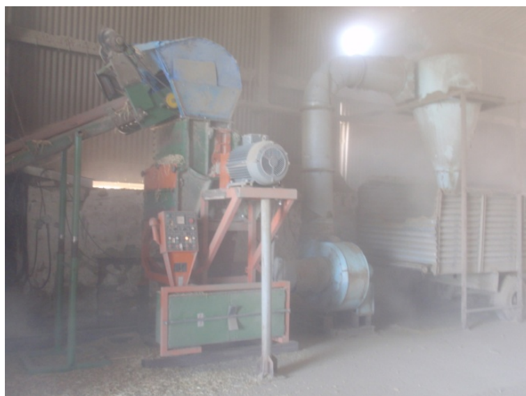
Obr. 17 Zleva – řezačka, ventilátor, cyklon a rozdrůžovací stůl
