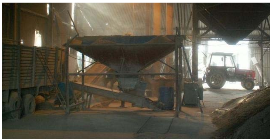
Obr. 18 Zásobník se šnekovým dopravníkem
