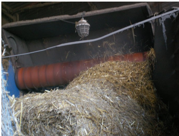
Obr. 16 Rotující nožový válec na rozdrůžovacím stole
