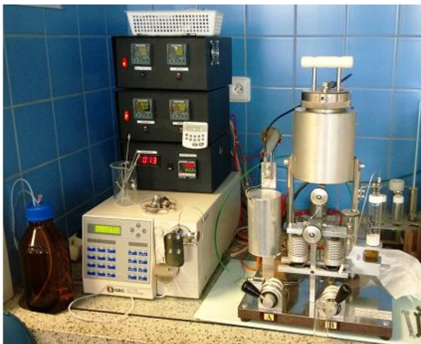
Obr. 5: Nekomerční přístroj pro extrakci kapalinou za zvýšeného tlaku
