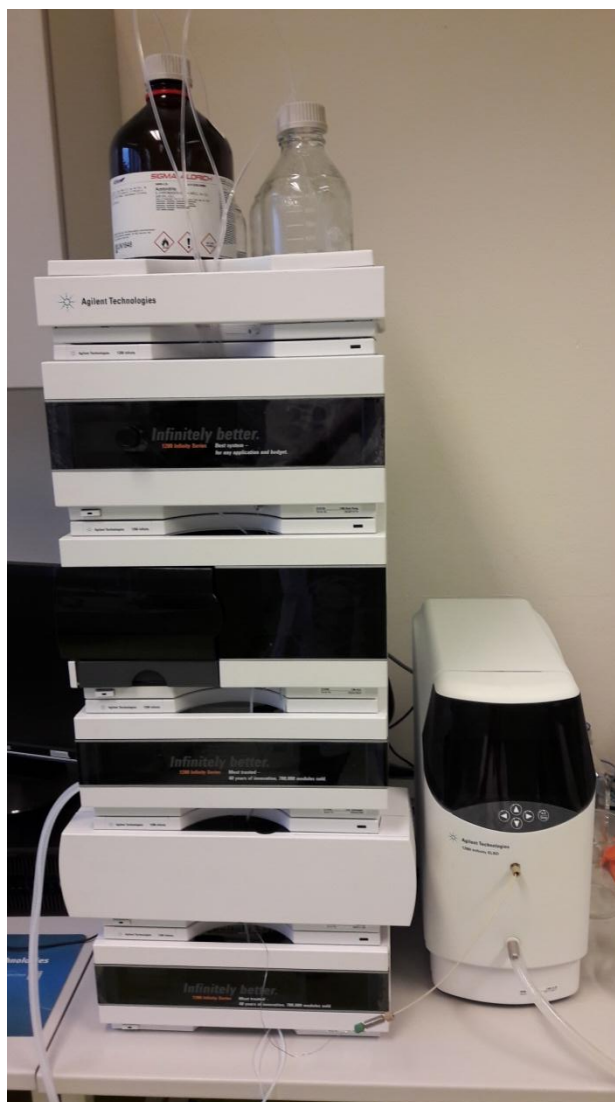
Obr. 9: Kapalinový chromatograf Agilent Infinity 1260
