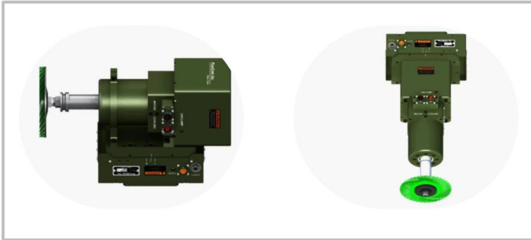
Obrázek 16) Rotační brousící hlava s aktivním odměřováním [22]
