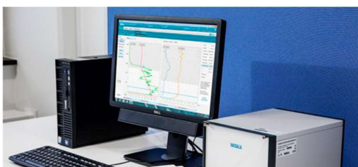
Obr.10 Systém MW41 pre vyhodnocovanie dát a testovanie rádiosond [31]
