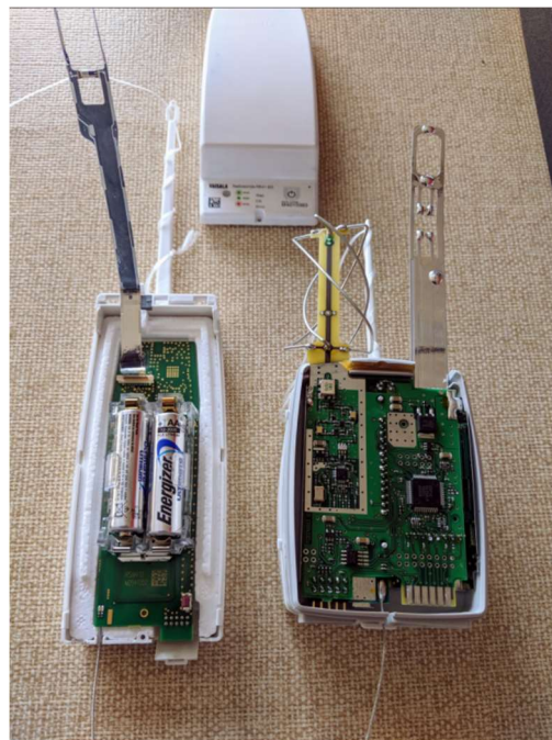
Obr.11 Vnútro rádiosondy RS41 (vpravo) a rádiosondy RS92 [32]
