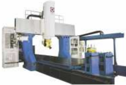
(Obr. 26.) Portálové obráběcí centrum FRF [20] (výrobce TOS Kuřim, ČR)
