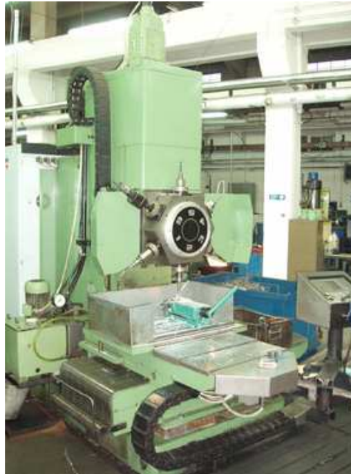
(Obr. 23.) Souřadnicová vrtačka VXR 50 CNC s revolverovou hlavou [12] (rok výroby 1988)
