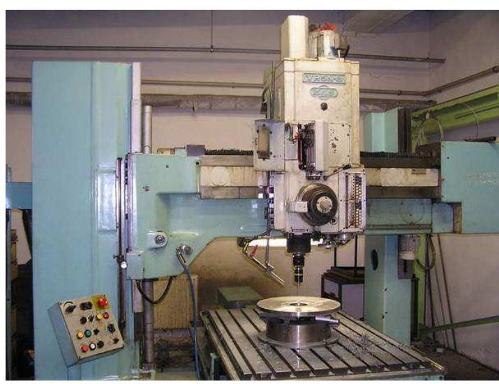
(Obr. 20.) Souřadnicová vrtačka VR 5 NC [15] (rok výroby 1979, výrobce Kovosvit Sezimovo Ústí, ČR)
