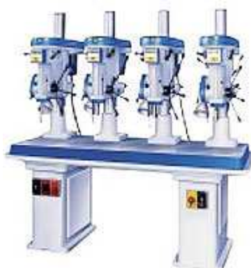
(Obr. 5.) Řadová vrtačka VR 4/20B [13] (výrobce Heltos, ČR)
