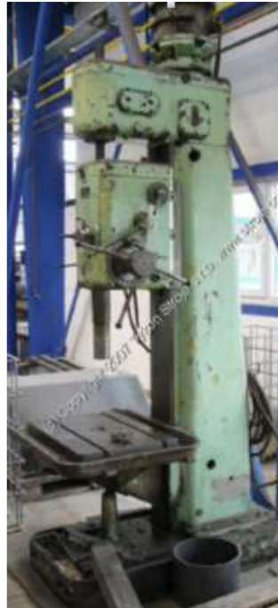
(Obr. 13.) Stojanová vrtačka BN 50 [21] (rok výroby 1951, výrobce TOS, ČR)
