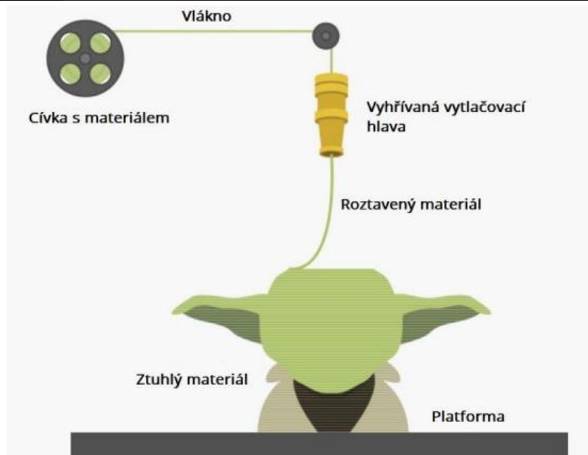
Obr. 21) Metody založené na extruzi (FDM, FFF) [27]
