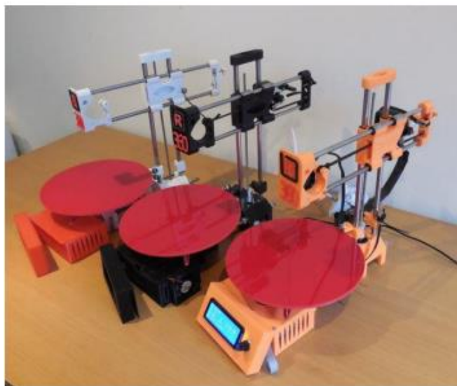
Obr. 25) 3D tiskárny R-360 konstrukčního typu Polar [42]
