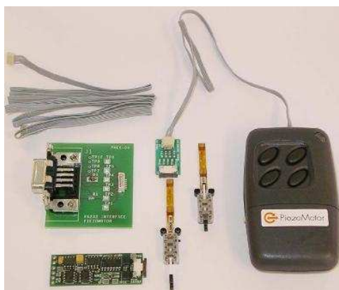
Obr. 27. Struktura Piezowave motoru s ručním ovladačem a komunikačním portem pro řízení pomocí PC
