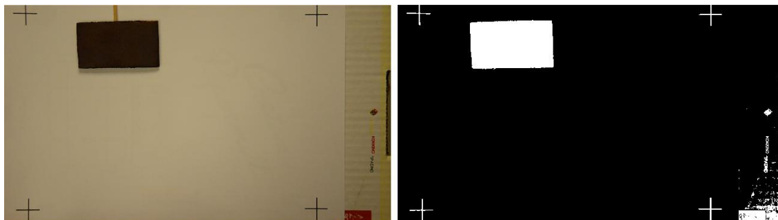
Obr. 2.4: Obrázek získaný kamerou (vlevo) a vyprahovaný binární obrázek
