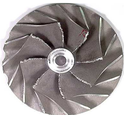
Obr. 1.2 Lopatkové kolo turbodmychadla poškozené cizím tělesem [2]
