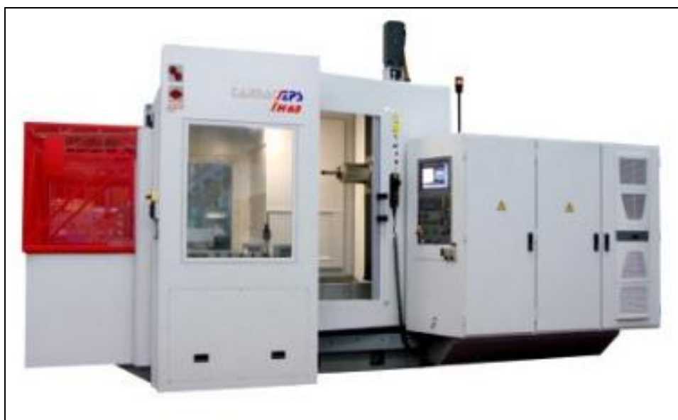
Obr. 1.1 Horizontální obráběcí centrum H63 STANDARD, výrobce TAJMAC-ZPS. 21
