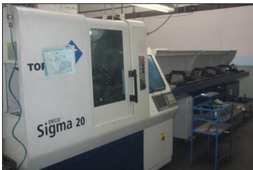
Obr. 3.1 Multifunkční obráběcí stroj, dlouhotočný automat Deco – Sigm 20, Tornos.
