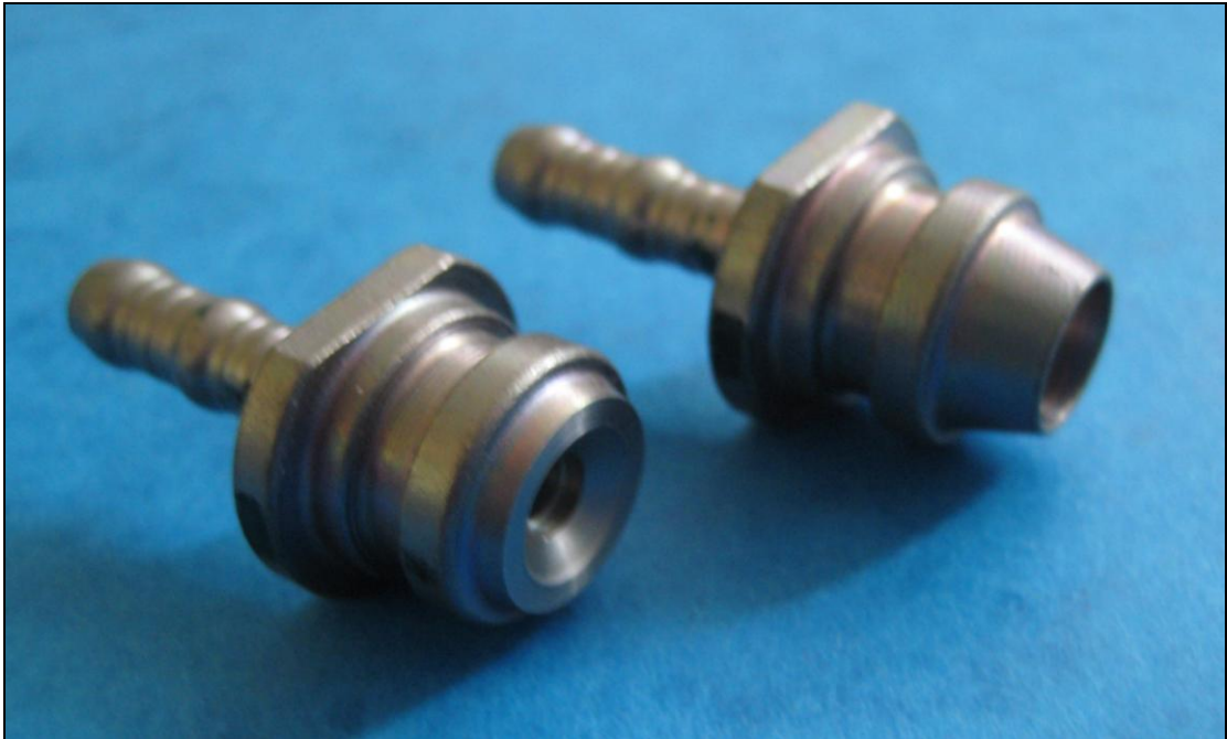
Obr. 3.9.1 Ukázka potřebné úpravy pro měření drsnosti – porovnání.
