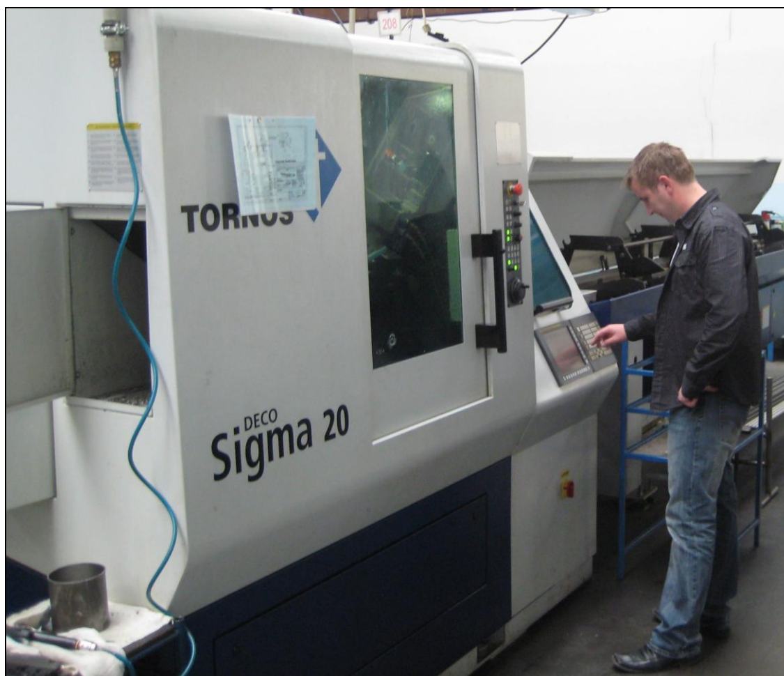
Obr. 1.5 Multifunkční obráběcí stroj Deco – Sigma 20, Tornos. 10
