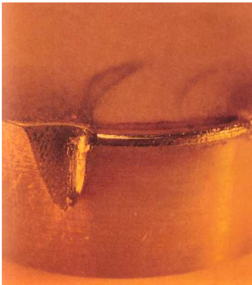
Obr. 1.5 Opotřebení ve tvaru vrubu na hlavním hřbetě břitu (1)
