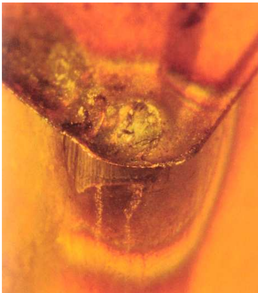
Obr. 1.4 Opotřebení ve tvaru žlábků na čele bříty (1)
