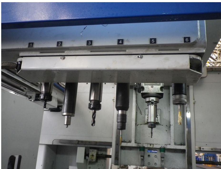
Obr. 4.6 Zásobník nástrojů v ose č. 2.
