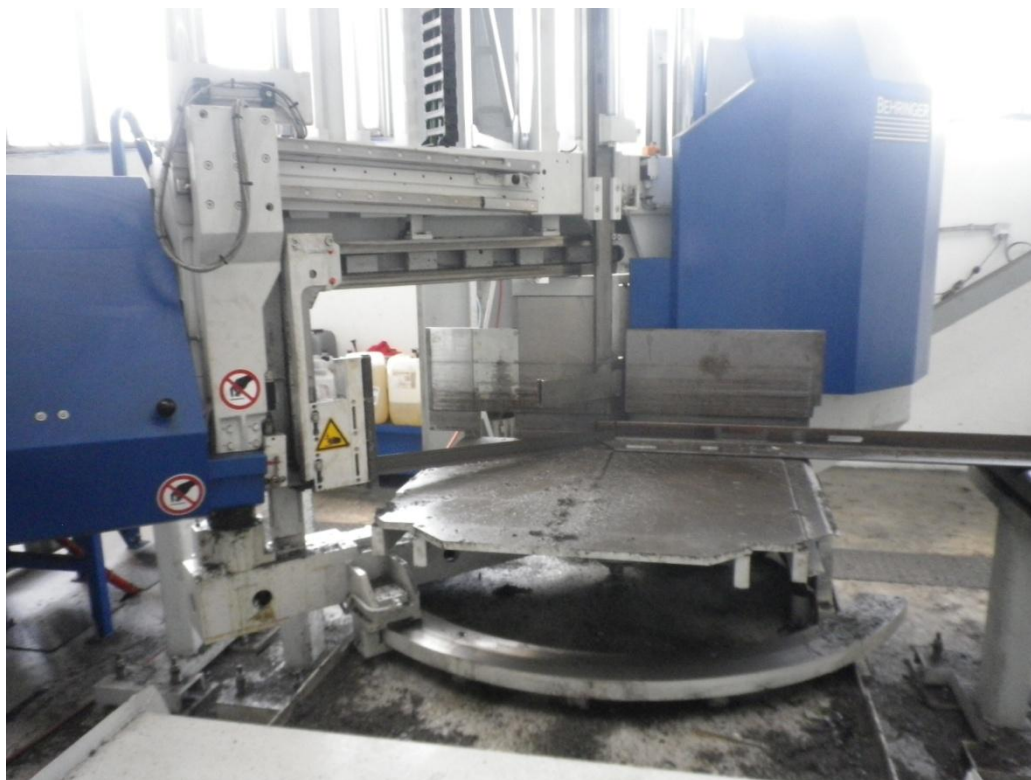
Obr. 4.32 Poslední operace – řezání součásti.
