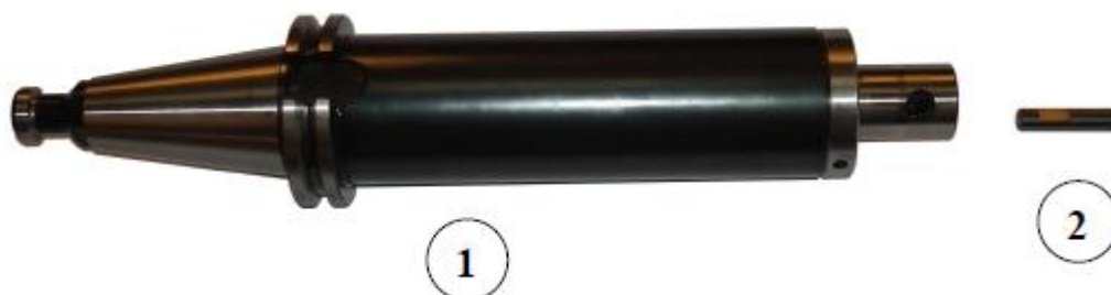
Obr. 4.2 Držák nástroje (1) a hrot jehly (2).
