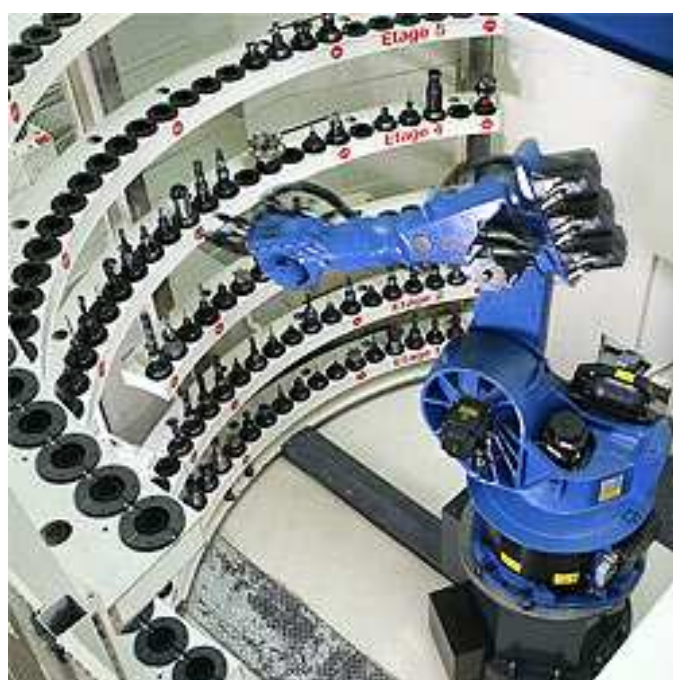
Obr. 21 Výměna frézovacích nástrojů robotem KUKA. [31]
