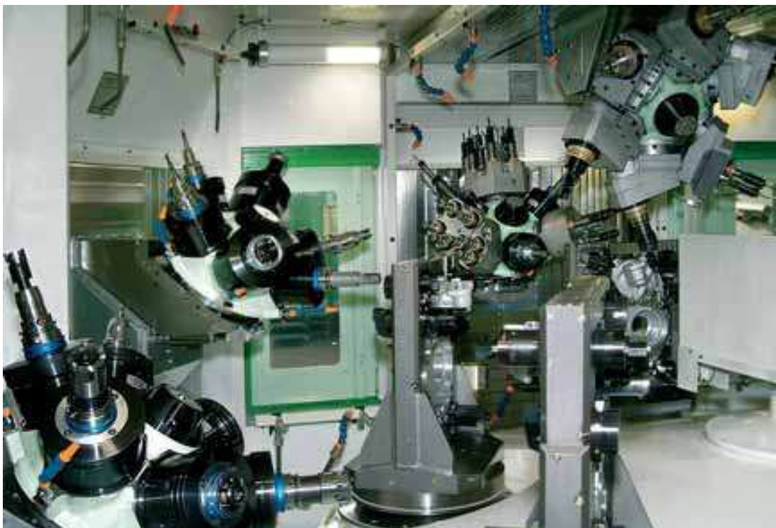
Obr. 11 Frézovací centrum s více vřetenovými i vícevřetenovými hlavami. [12]
