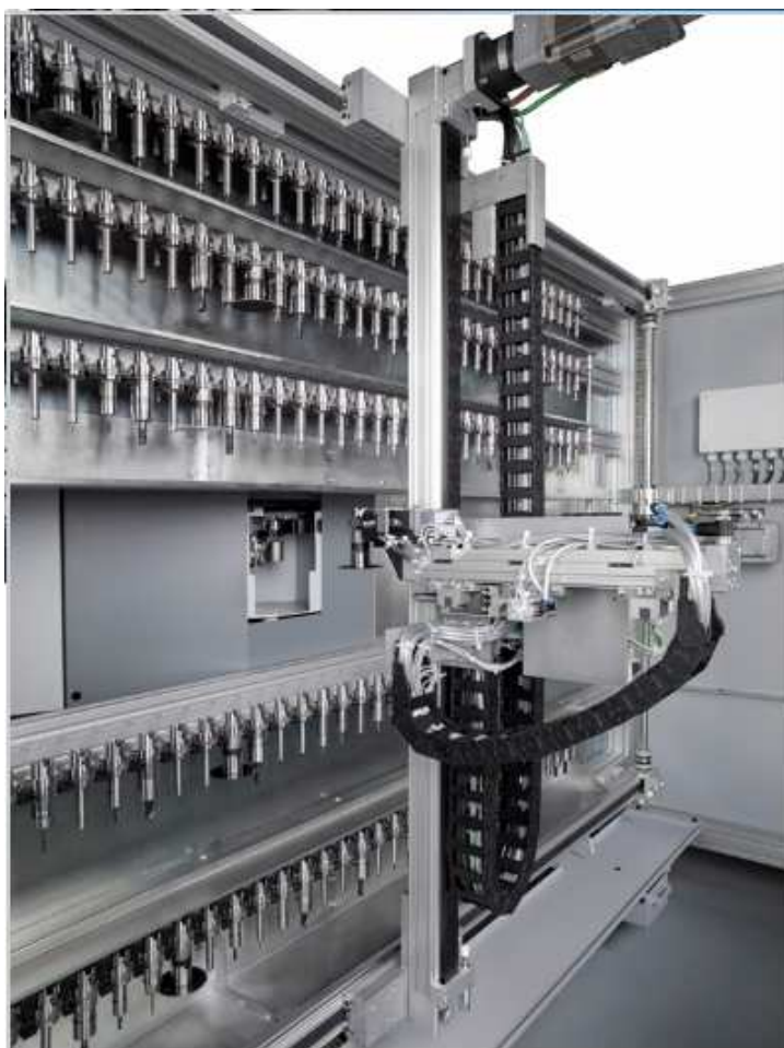
Obr. 28 Kombinovaný zásobník firmy Chiron. [22]
