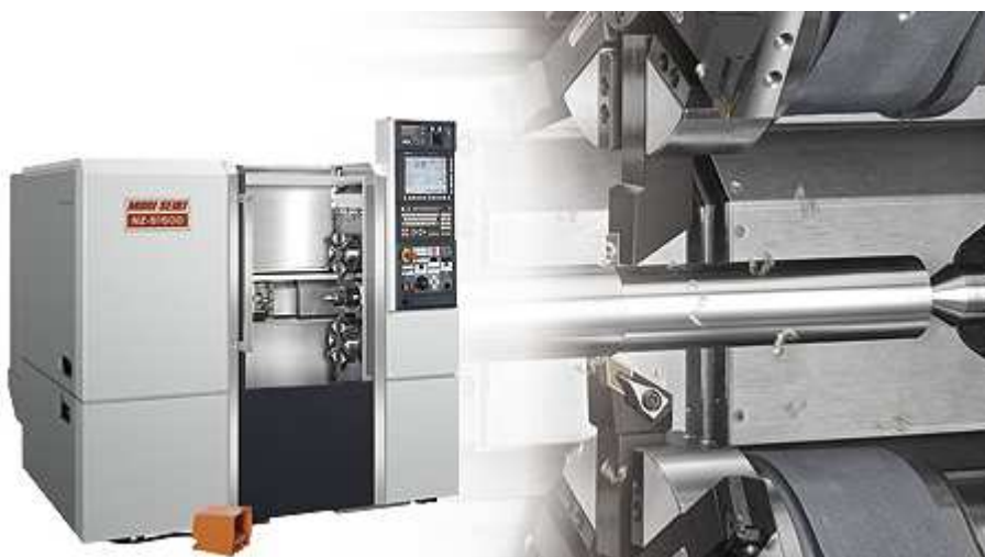
Obr. 3 Použití dvou revolverových hlav. [13]
