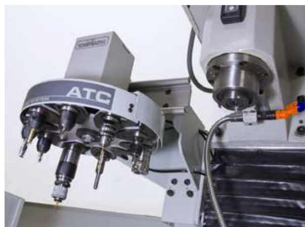
Obr. 13 PICK-UP zásobník s možností posuvu. [17]
