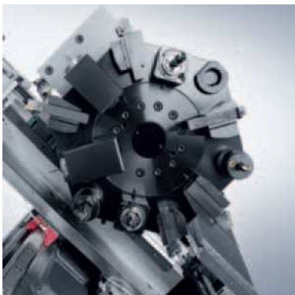
Obr. 8 Revolverová hlava s poháněnými i nepoháněnými nástroji. [11]
