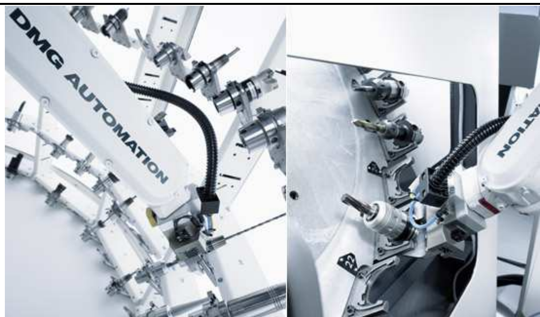
Obr. 32 Pohled dovnitř robotické buňky frézovacího centra DMG. [11]
