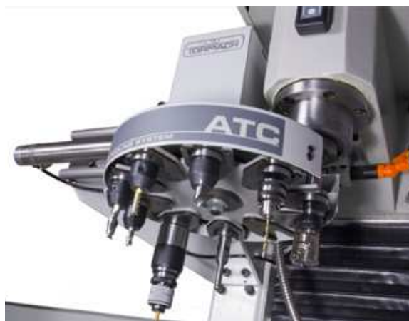
Obr. 14 PICK-UP zásobník v poloze pro výměnu nástroje. [17]
