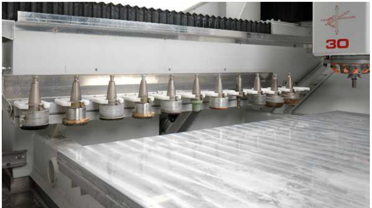
Obr. 16 Lineární zásobník Intermac na stroji Master 30. [19]
