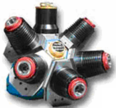
Obr. 6 Revolverová hlava s mimoběžnými osami. [9]
