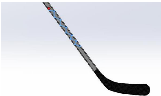
Obr. 12 Systém detekce poruch pomocí měděných vodičů v hokejce [29].
