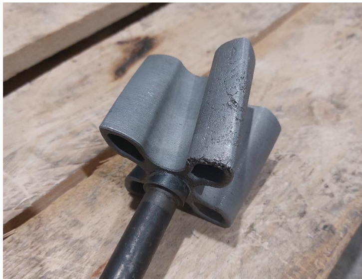
Obr. 26 Povrchová pórovitost prototypového odlitku.
