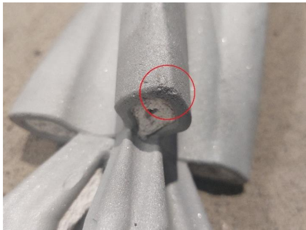
Obr. 42 Detail na pórovitost na špičce jedné z lopatek.
