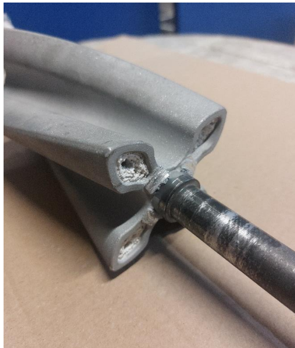
Obr. 40 Odlitek po kompletním odstranění vtokové soustavy.
