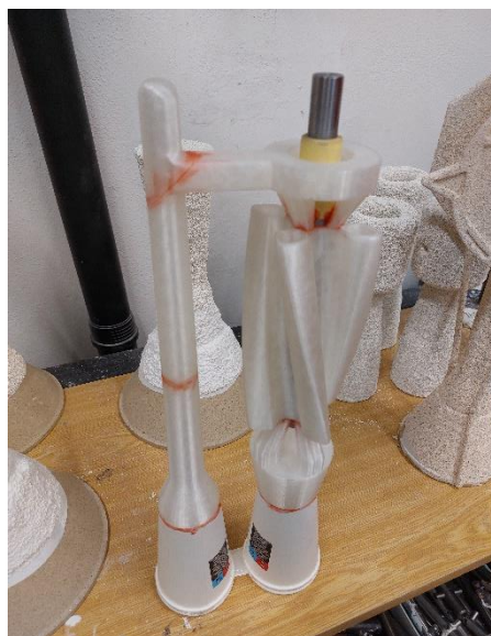
Obr. 35 Kompletní sestava připravená k lití.
