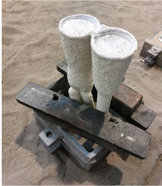
Obr. 37 Rotor těsně po odlití podepřený ocelovými ingoty.
