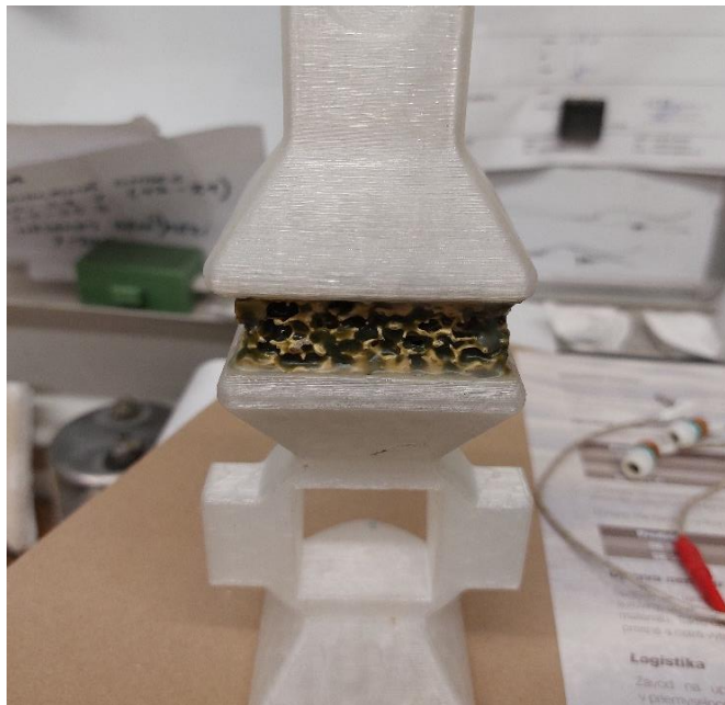
Obr. 43 Pěnový keramický filtr připojený na vtokovou soustavu.
