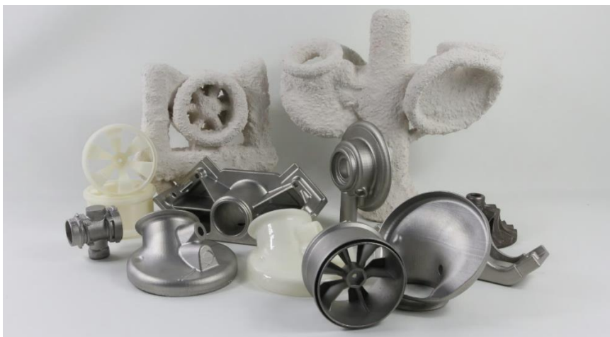
Obr. 3 Modely z materiálu PolyCast, skořepiny a hotové odlitky [12].
