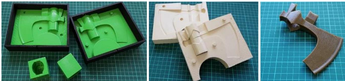
Obr. 4 Pozitiv vytisknutý na 3D tiskárně, Lukoprenová forma, hotový voskový model [10].
