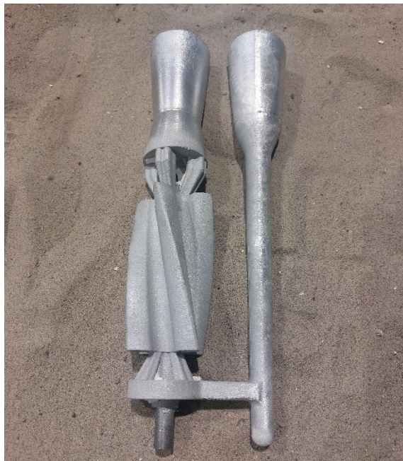
Obr. 38 Odlitek po odstranění skořepiny.
