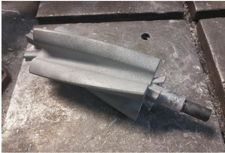
Obr. 39 Odlitek po ručním odstranění vtokové soustavy.
