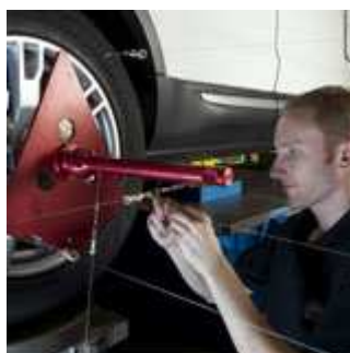
Obrázek 13: Připojení lankových potenciometrů k vyvážené desce [23]
