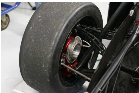
Obrázek 7: Zvláštní případ svařovaných trojúhelníkových ramen [20]
