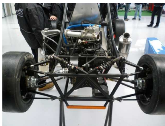
Obrázek 6: Svařovaná trojúhelníková ramena z oceli [20]
