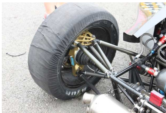
Obrázek 8: Trojúhelníková ramena z kompozitních materiálů [20]
