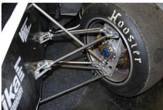
Obrázek 5: Ramena tvořená tyčemi z kompozitního materiálu [20]
