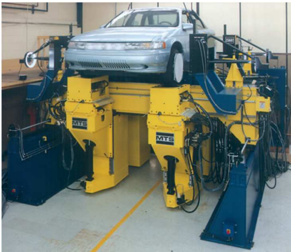
Obrázek 15: MTS K&C System [6]
