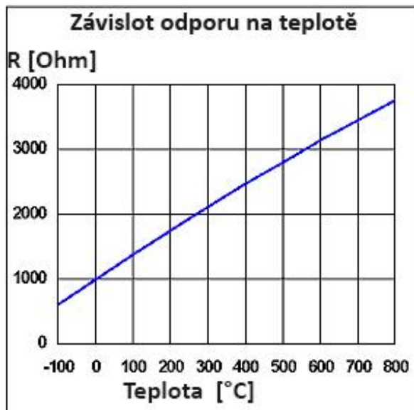
Obr. 5 - Závislost odporu na teplotě u čidla PT1000 [ 2 ]
