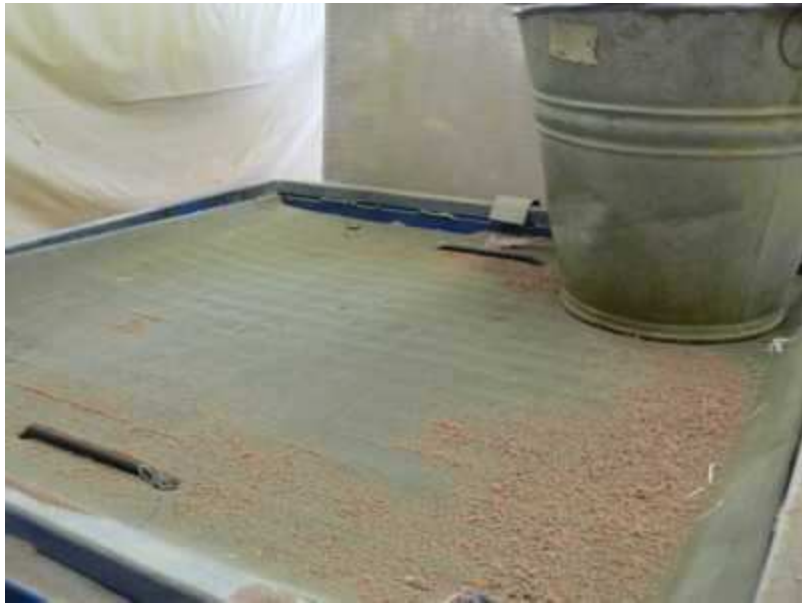
Obr. 13 Síto, kterým se sype do zásobníku další abrazivo
