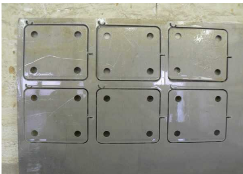
Obr. 12 Ukázka výřezků v plechu, které se budou vylamovat
