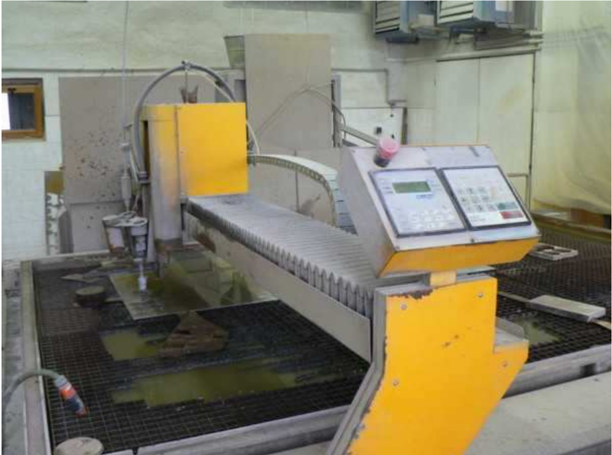
Obr. 4 Pohled na zařízení, nalevo položená tryska pro oplachování a napravo ruční řídicí panel
