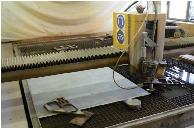
Obr. 7 Plech na roštu zajištěný závažími proti posunutí
