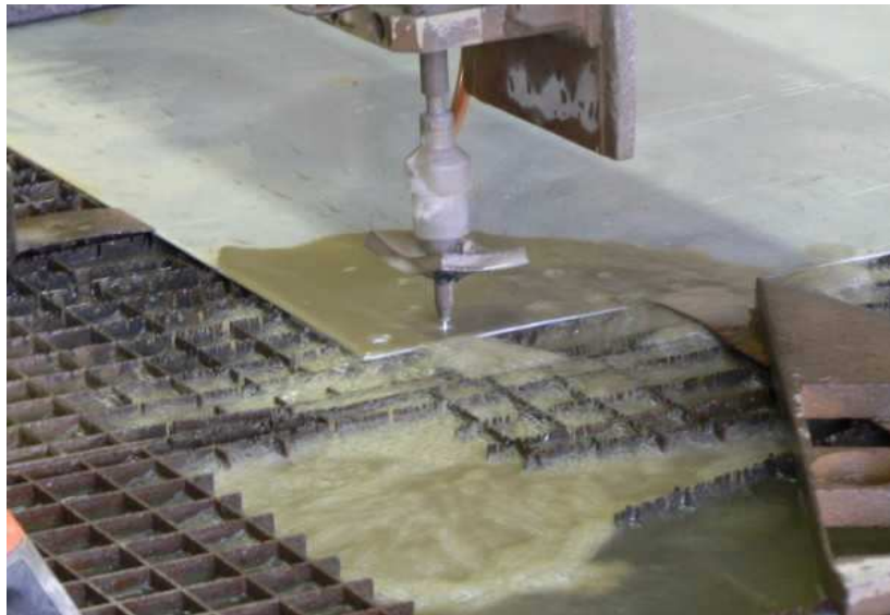
Obr. 8 Vodní paprsek na začátku práce
