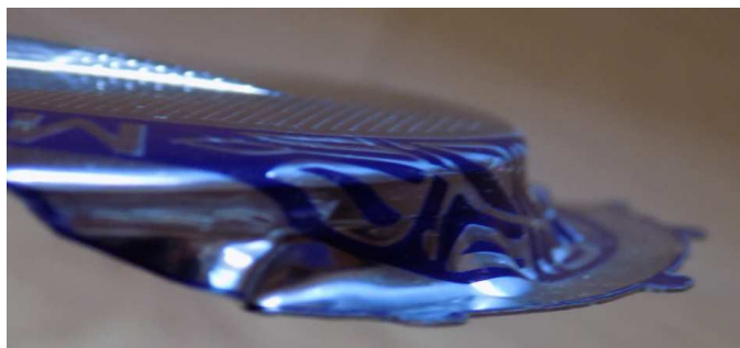
Obr. 21 Špatně založený polotovar
