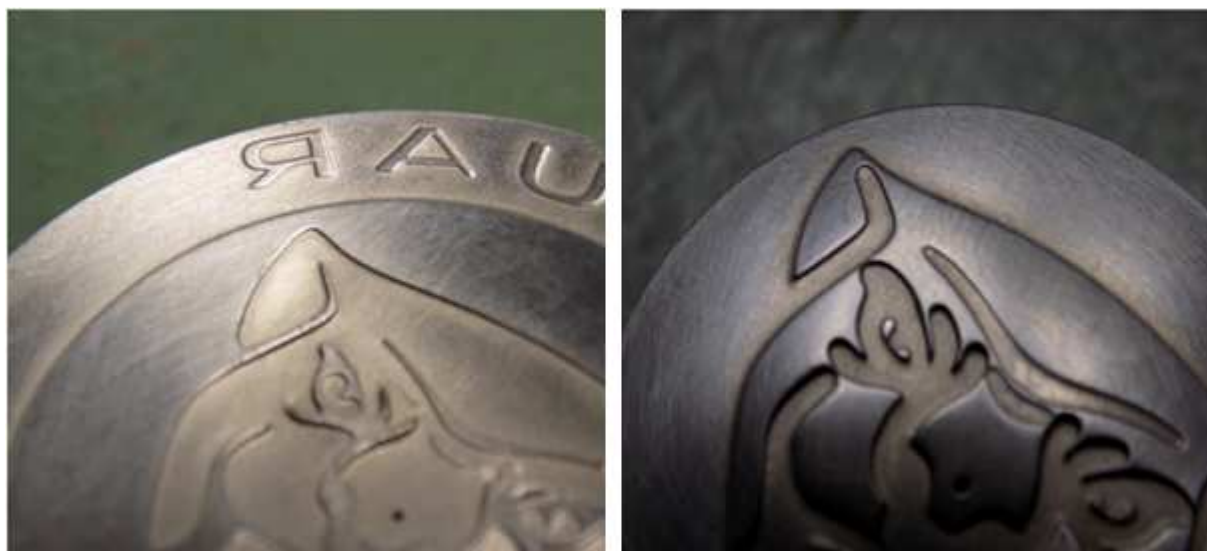
Obr. 20 Detail raznice a razníku
