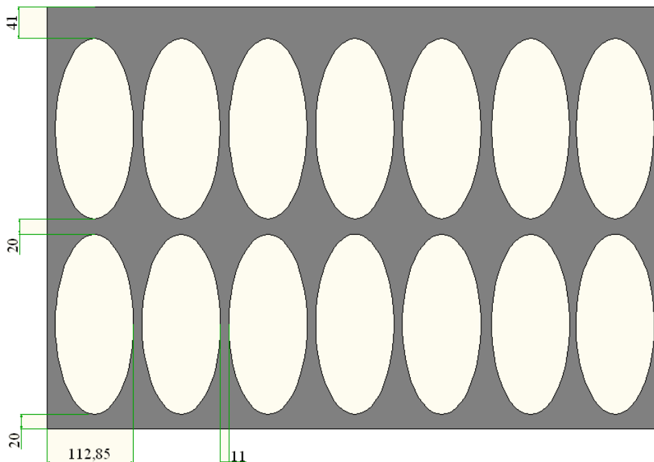
Obr. 30 Vystřížený plech pro variantu a i )
