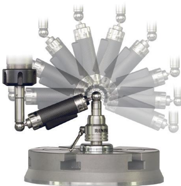
Obr. 27) Ukázka testování systému Ballbar v praxi (7).
