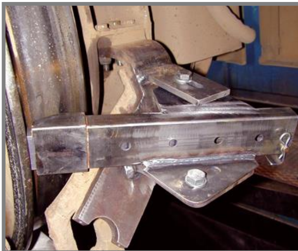
Obr. 1.14 Aplikace tuhého maziva Kelsan LCF [8]
