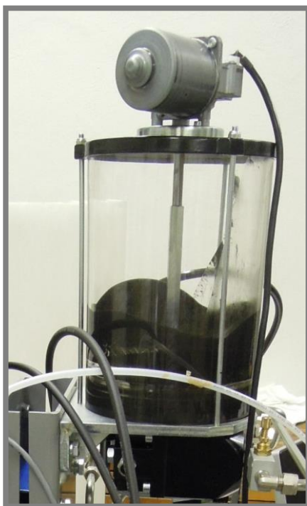
Obr. 4.2 Nádrž mazacího přístroje s mazivem Mogul Eko OK
