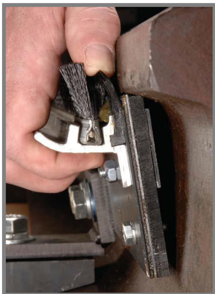
Obr. 1.4 Detail dávkovací desky systému Lincoln Wayside Lubricator [10]
