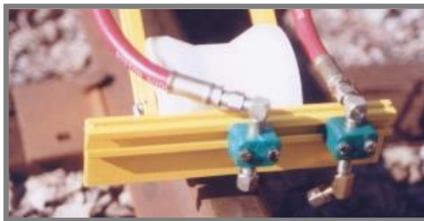
Obr. 1.3 Detail výstupních trysek mazacího systému ROAD-RUNNER [9]
