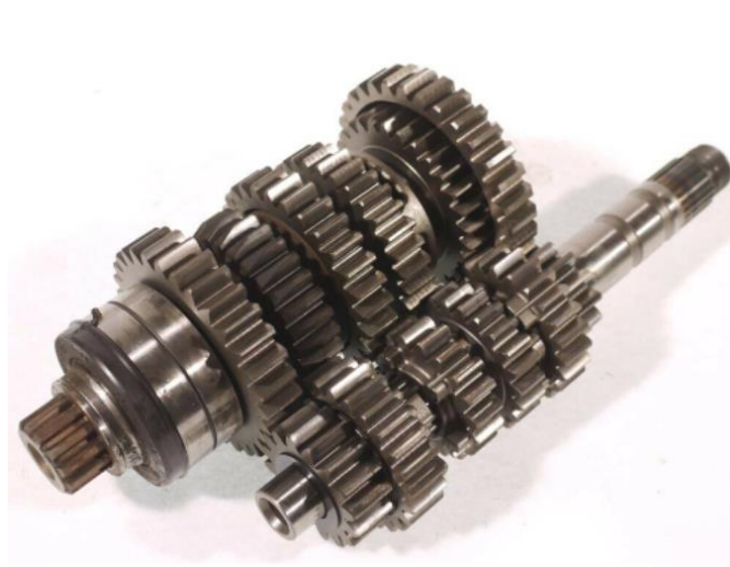
Obrázek 18: 6-stupňová převodovka Honda CBR600 [34]
