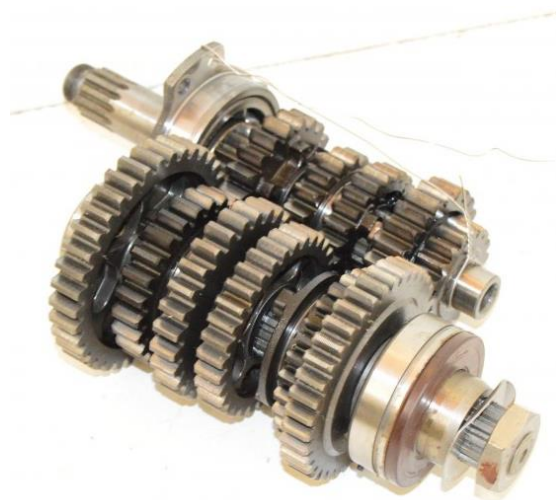
Obrázek 19: 6-stupňová převodovka Yamaha YZF-R6 [33]
