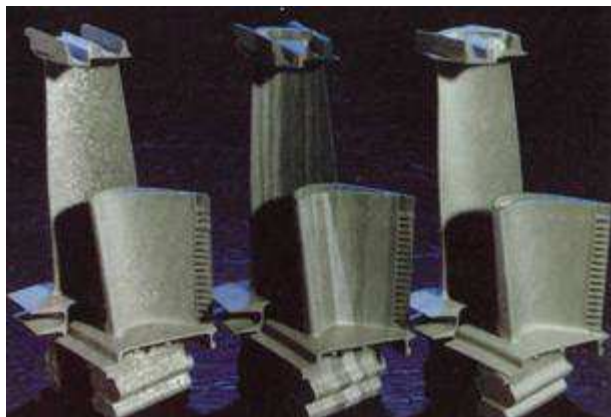
Obr. 5. Lopatka leteckého motoru – rovnoosá struktura, usměrněná krystalizace, monokrystal [9]
