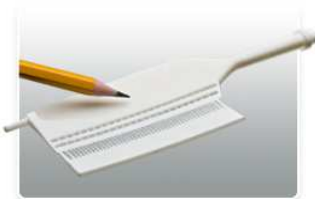
Obr. 1 Jádro pro systém chlazení lopatek parní turbíny [1]
