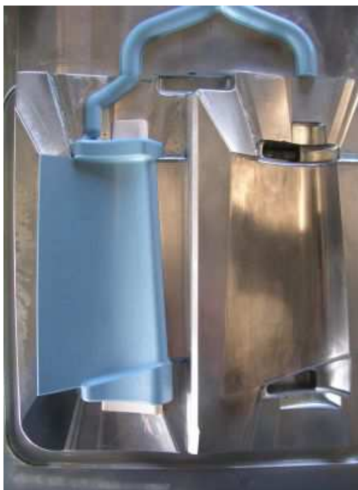
Obr. 13. Keramické jádro uvnitř formy obalené voskovým modelem [16]
