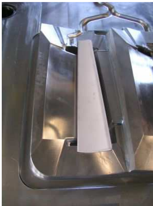
Obr. 12. Keramické jádro umístěné do formy před vytvořením voskového modelu [16]
