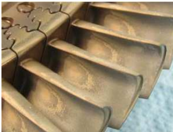
Obr. 20. Teplotně a oxidačně poškozený povrch lopatek turbíny [28]
