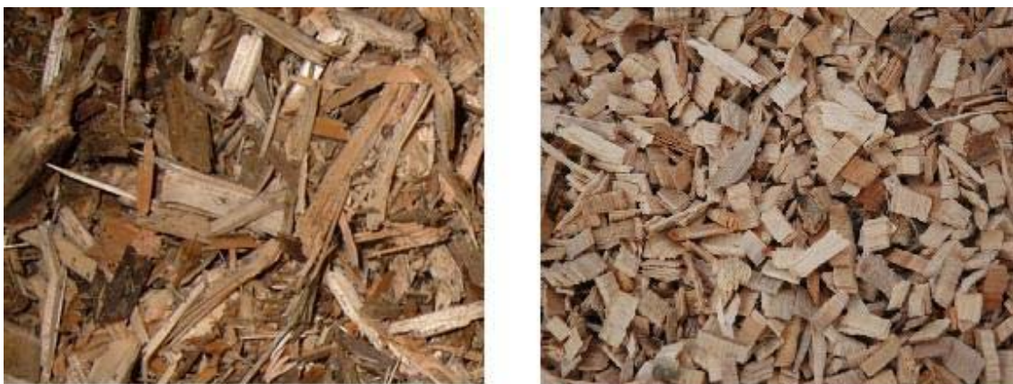
Obrázek 2.6: Dřevní štěrka vyrobená kladivovým drtičem a nožovým štěpkovačem [42]
