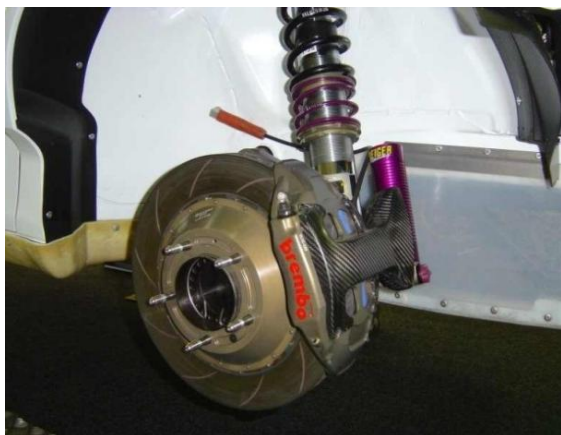
Obr. 41 Přední náprava (vlevo) a nastavování geometrie zadní nápravy vozu Škoda Fabia S2000 jezdce Romana Kresty [20]
