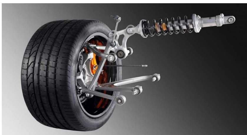
Obr. 45 Kolo zadní lichoběžníkové nápravy vozu Lamborghini Aventador s pushrod odpružení [16]
