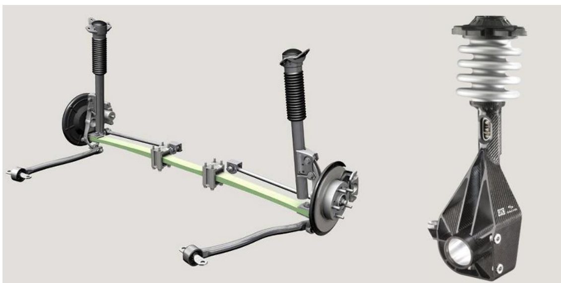
Obr. 46 Zadní náprava MacPherson s listovou kompozitní pružinou (vlevo) a modul přední nápravy MacPherson z kompozitu vyztuženým uhlíkovými vlákny [16],[19]
