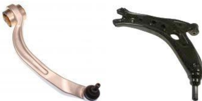
Obr. 12 Jednoduché rameno přední víceprvkové nápravy vozu Škoda Superb (vlevo) a trojúhelníkové rameno přední nápravy MacPherson vozu Škoda Fabia [12]
