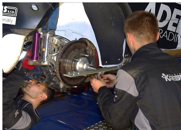
Obr. 41 Přední náprava (vlevo) a nastavování geometrie zadní nápravy vozu Škoda Fabia S2000 jezdce Romana Kresty [20]
