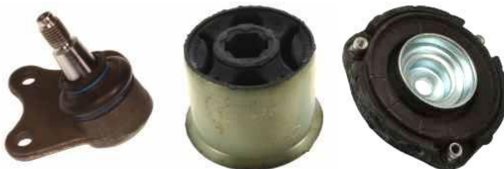
Obr. 13 Kulový čep, pryžové lůžko uložení ramene a uložení tlumiče přední nápravy MacPherson vozu Škoda Fabia [12]
