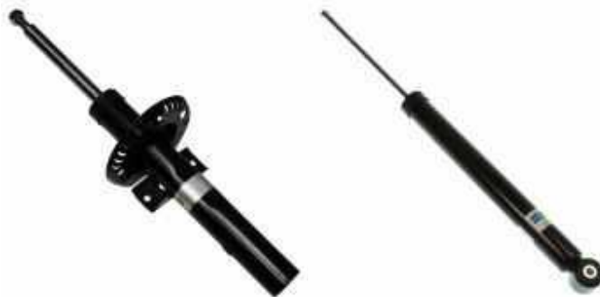
Obr. 14 Přední (náprava MacPherson) a zadní tlumič vozu Škoda Fabia [12]
