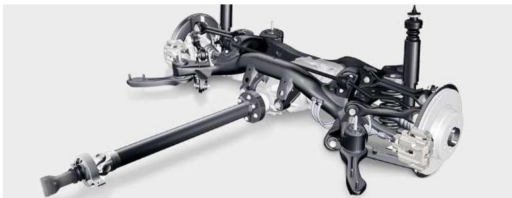
Obr. 26 Zadní víceprvková náprava vozu BMW řady 1 s pomocným rámem [6]
