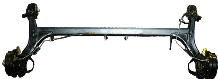
Obr. 32 Kliková náprava se spřaženými rameny [23]
