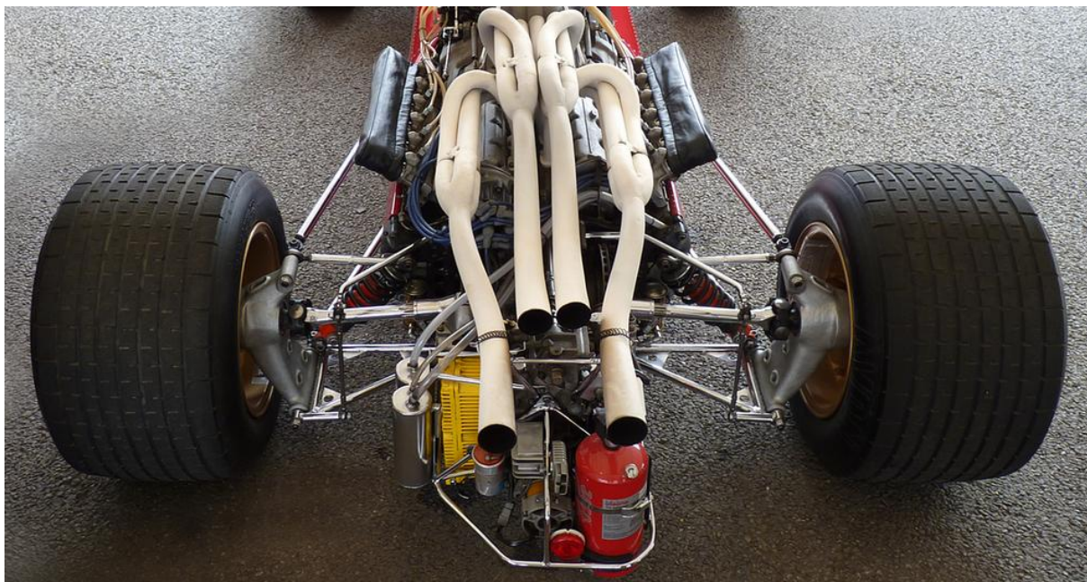
Obr. 22 Zadní lichoběžníková náprava závodního vozu Ferrari 312 z roku 1968 [22]
