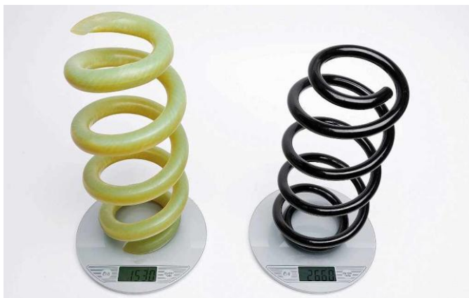
Obr. 47 Porovnání kompozitní pružiny společnosti AUDI s klasickou ocelovou pružinou [16]
