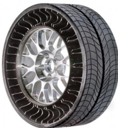
Obr. 49 Bez-vzduchové kolo Tweel společnosti Michelin [17]
