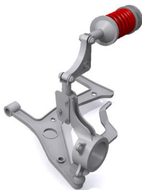
Obr. 18 Přední náprava vozů Rover 2000 a 3500 [8]
