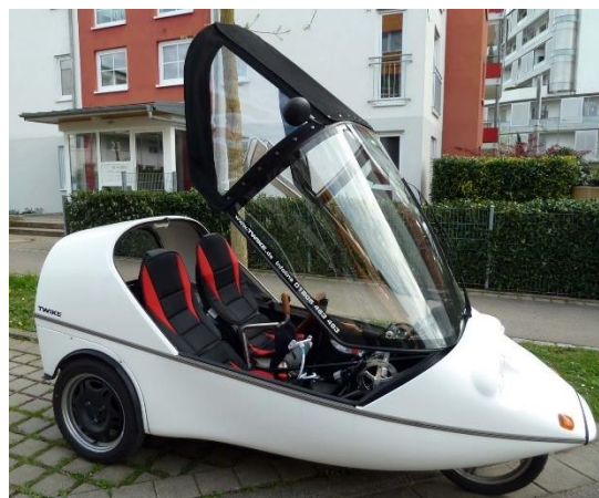
Obr. 6 Velomobil s plně uzavíratelnou karoserií [117]
