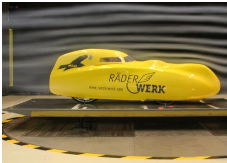
Obr. 30 Vizualizace proudění pomocí kouře [129]
