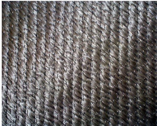
Obr. 2-5 Tkanina s vlákny jedním směrem
