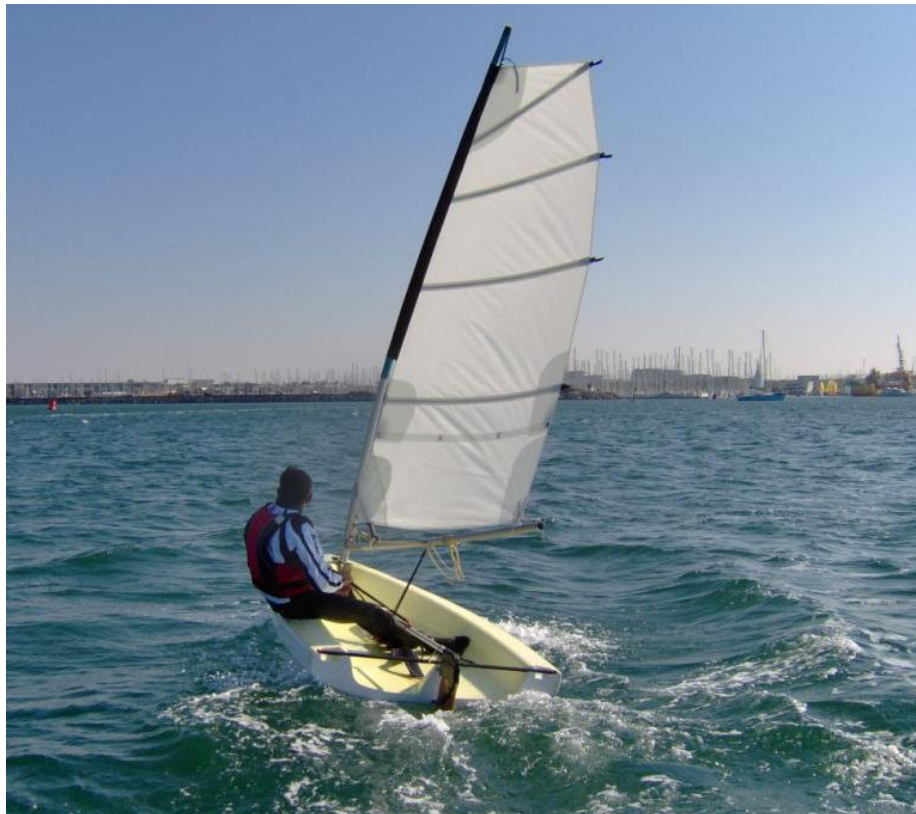
Obr.2-7 Trup malé plachetnice, materiál Twintext
