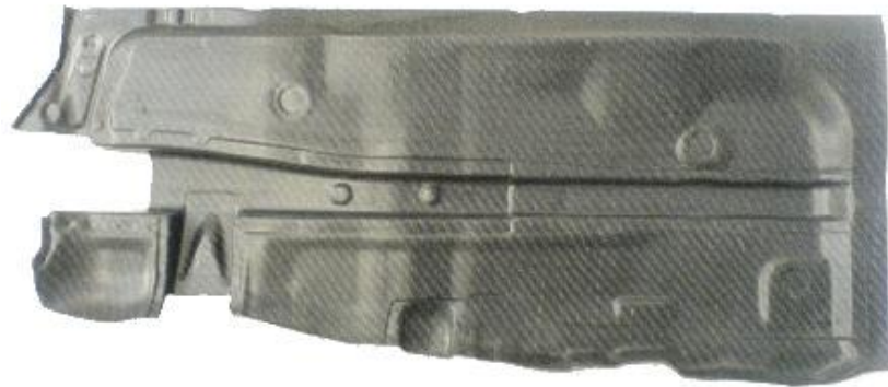
Obr.2-8 Dveřní panel Twintex + Kevlar
