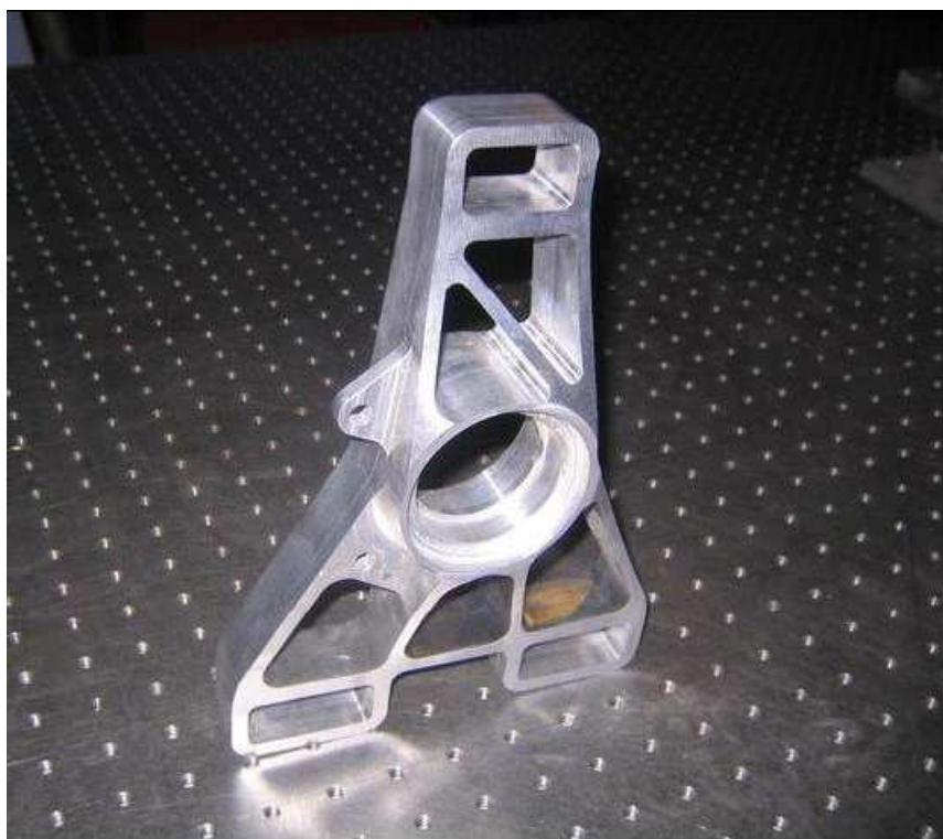
Obr. 10 Těhlice konstruovaná z lehkých slitin [2]
