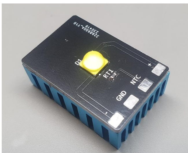
Obrázok 19 Plošný spoj výkonovej LED s chladičom
