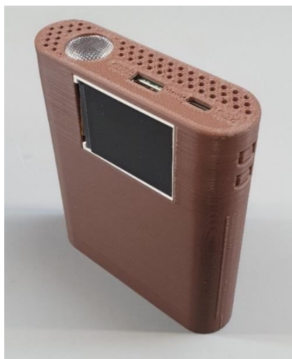
Obrázok 26 Obal vytvorený 3D tlačou s vloženými komponentami
