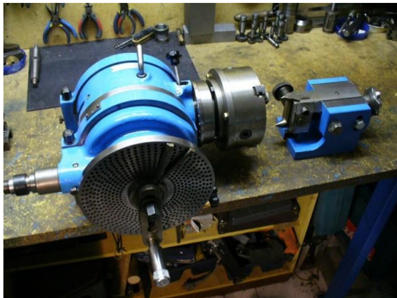
Obr. 2.2 Univerzální dělicí přístroj s výškově přestavitelným koníkem [22].
