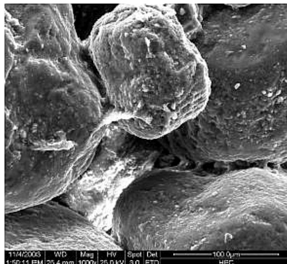
Obr. 12 Distribuce pojiva při použití vysokosmykového míchání [22].
