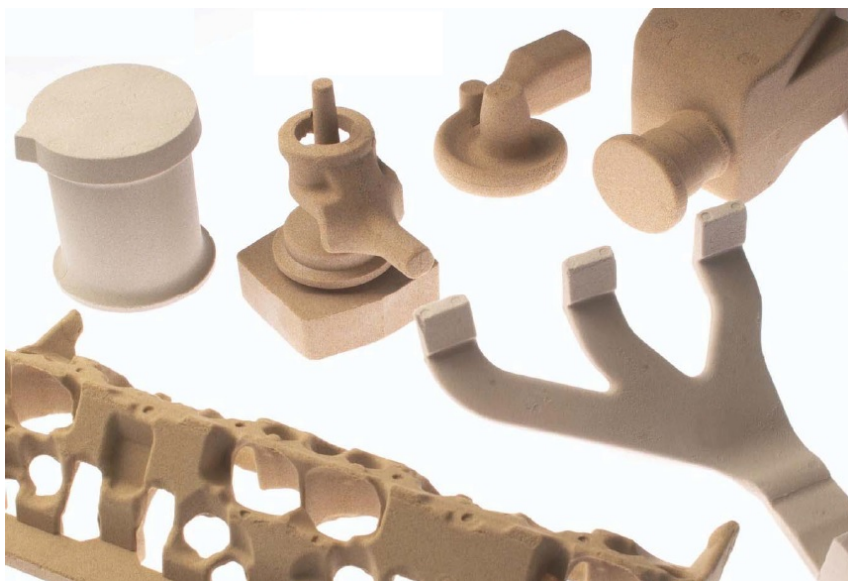
Obr. 15 Ukázka jader s pojivem GMBOND ® [25].
