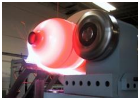
Obr 2-2 – Zkouška tlakové nádrže proti požáru [35]
