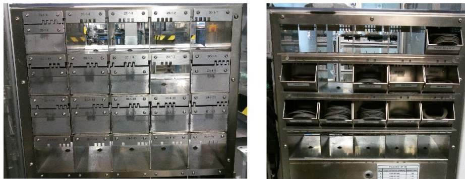
Obrázek 7) Poka Yoke v praxi - zásobníky na vymežovací podložky [2]
