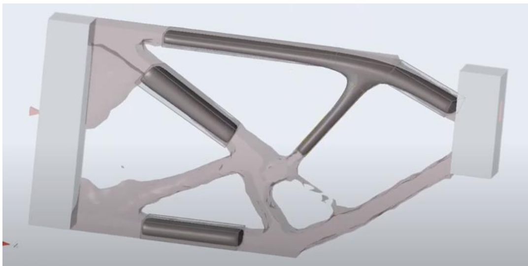
Obrázek 7. Dokončování optimalizace ručním způsobem [7]
