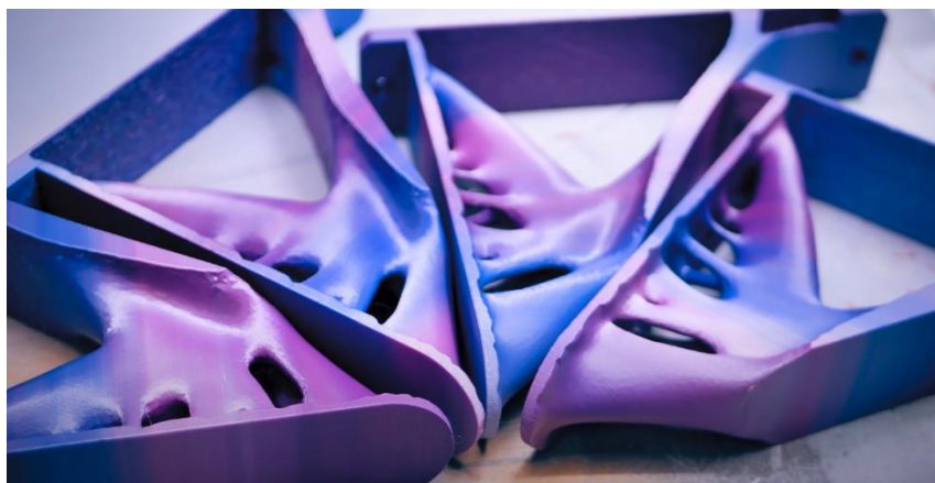
Obrázek 14. Topologický návrh konzole nástěnné police FDM [15]
