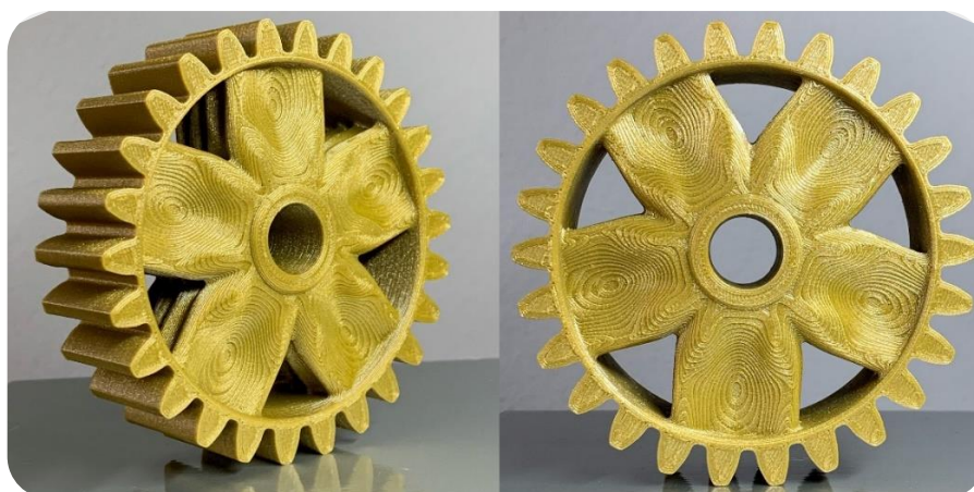
Obrázek 50. Topologicky optimalizované ozubené kolo
