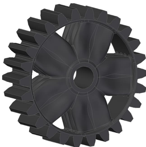
Obrázek 34. Finální podoba optimalizovaného ozubeného kola
