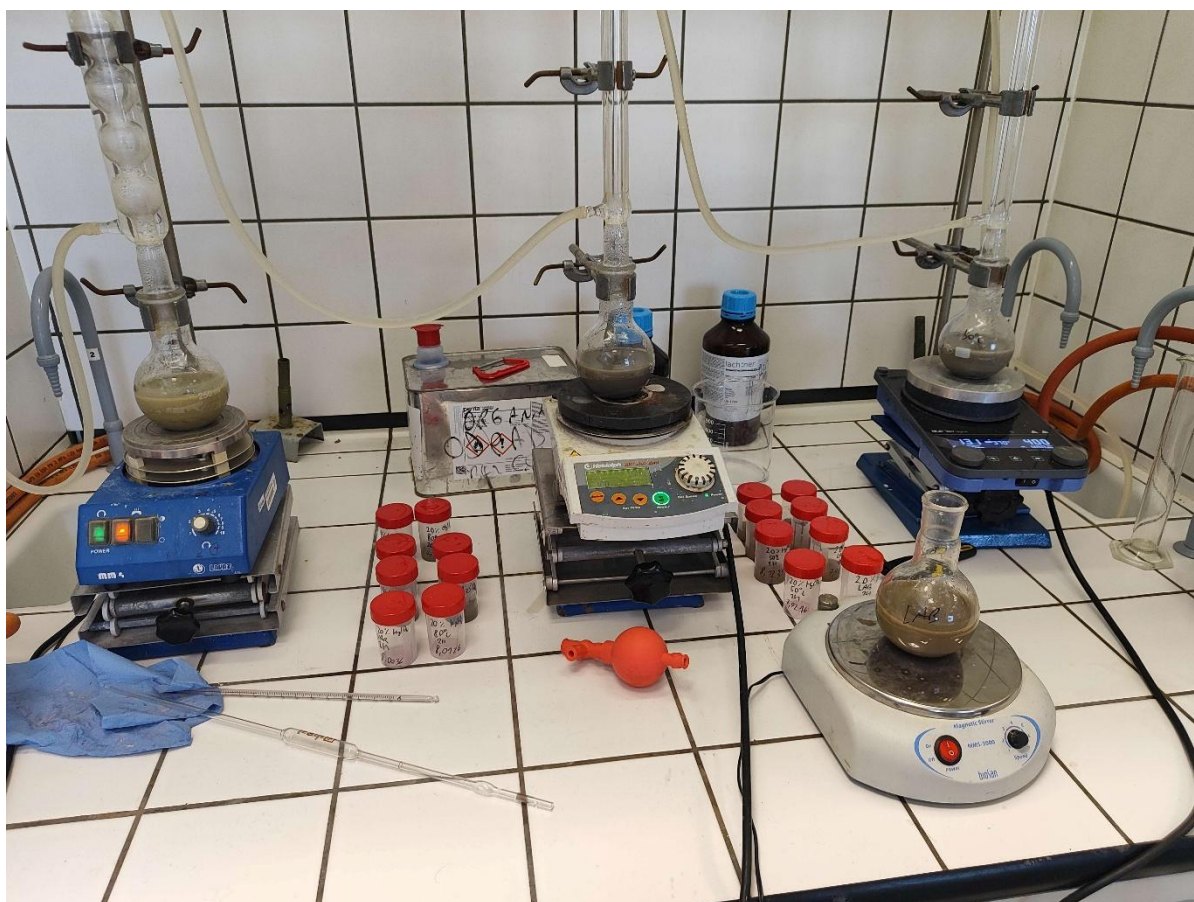
Obrázek: 20 Extrakční aparatura během extrakce Prestabu 20 % roztokem kyseliny sirové.
