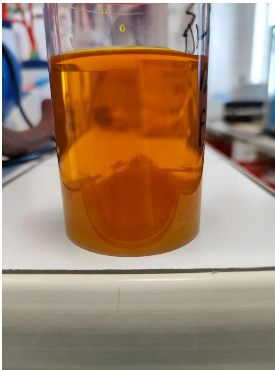
obrázek: 22 Vykrytalizované krystalky dihydrátu síranu vápenatého ve zfiltrovaném roztoku
