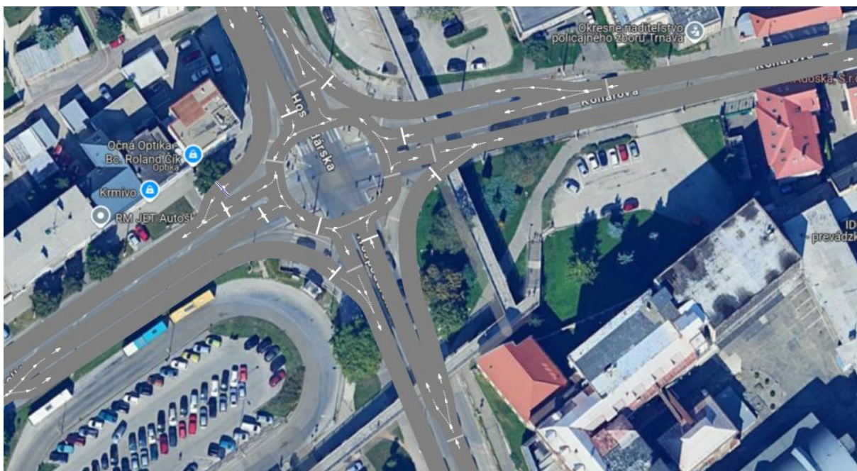
Obrázok č. 23: Návrh na riešenie okružnej križovatky č.1
