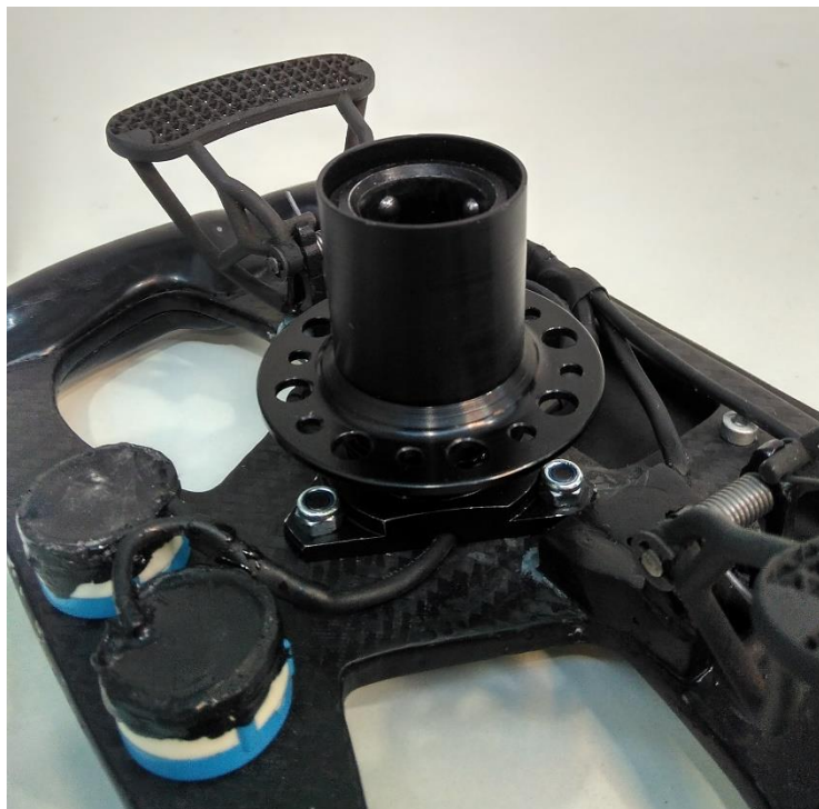
Obr. 19 Rychlospojka implementovaná do sestavy volantu
