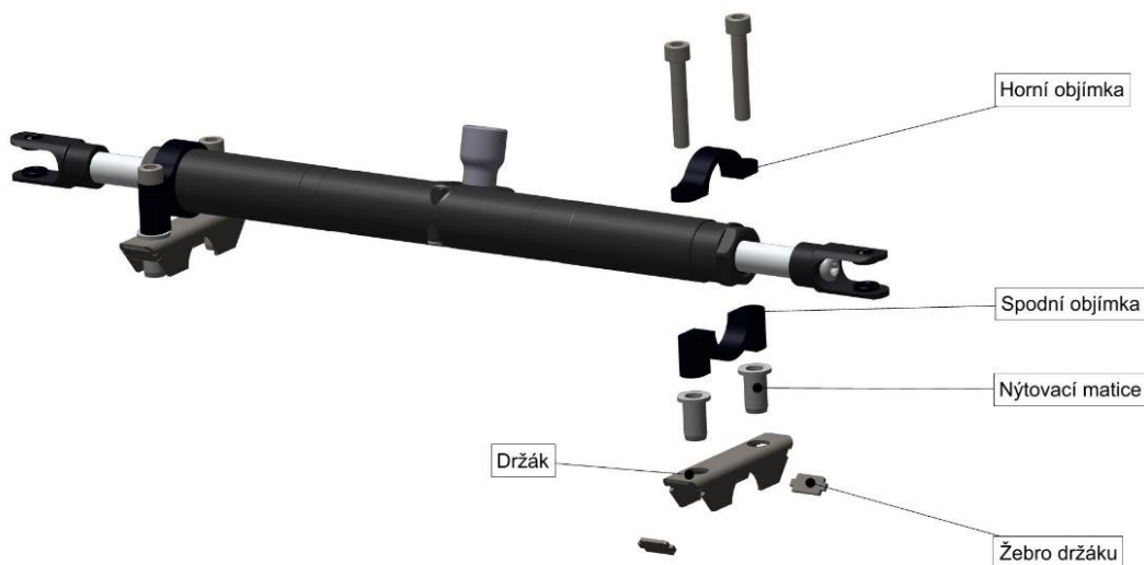
Obr. 29 Uložení hřebene řízení monopostu Dragon 6
