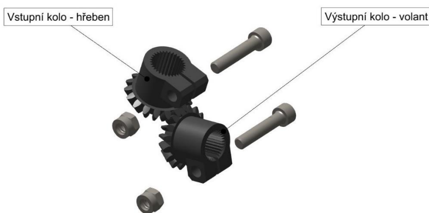
Obr. 30 Ozubená kola s vnitřním jemným drážkování v kombinaci se svěrným spojem (za vstupní ozubené kolo je považováno kolo umístěné na hřídeli směřující z hřebene)
