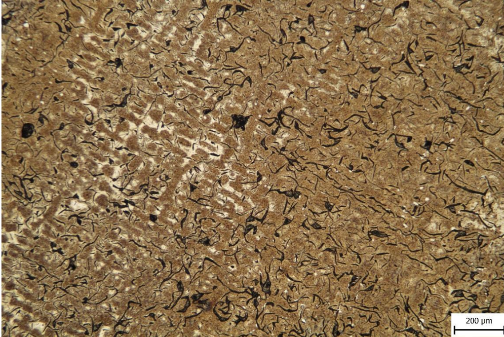
Obr. 32 Mikrostruktura vzorku 3B (4% feritu, 96% perlitu)
