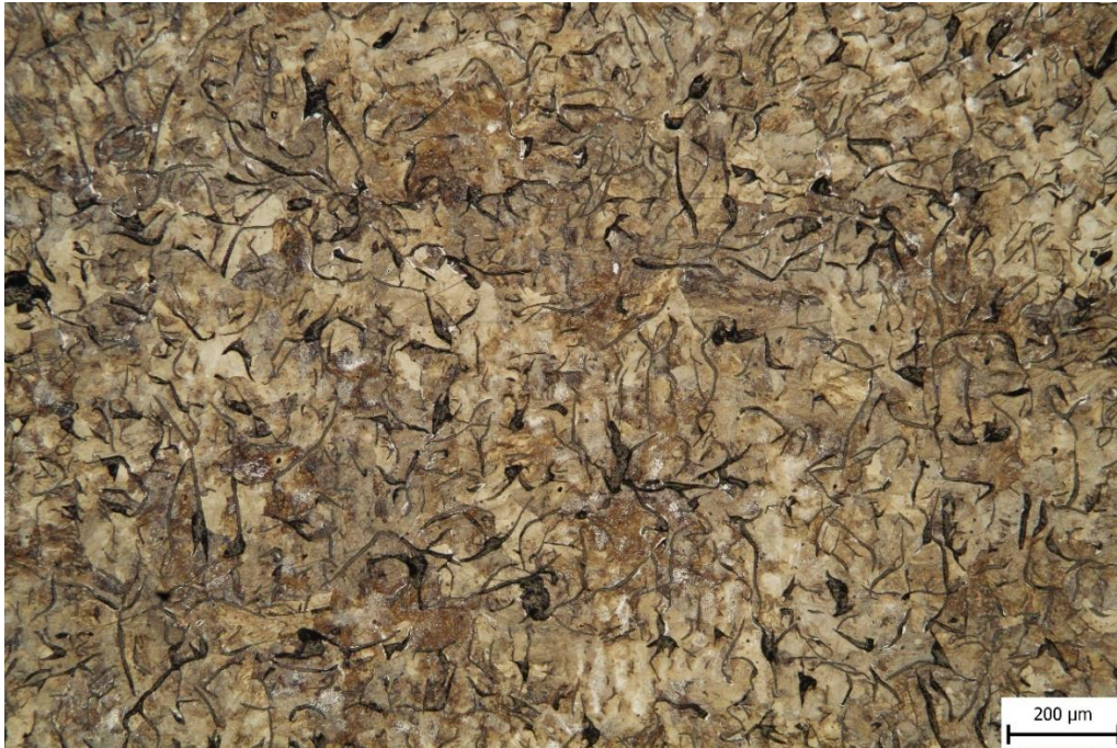
Obr. 30 Mikrostruktura vzorku 2B (0% feritu, 100% perlitu)
