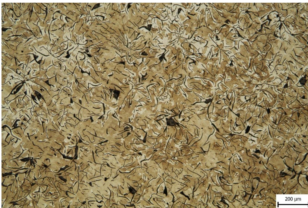
Obr. 31 mikrostruktura vzorku 3A (8% feritu, 92% perlitu)
