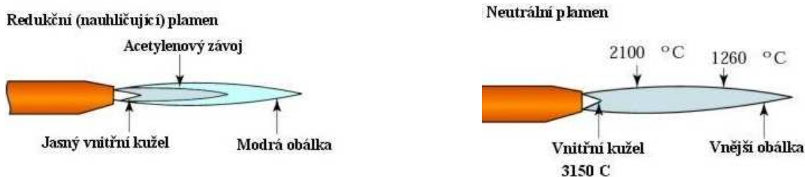
Obr. 5 Porovnání redukčního a neutrálního plamene [10]
