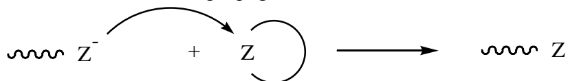
Obrázek 31: Nukleofilní atak propagačního aniontu na monomer. Z - je aniontové propagační centrum (např. alkoxid nebo karboxylát odvozený od cyklického monomeru) [III]
