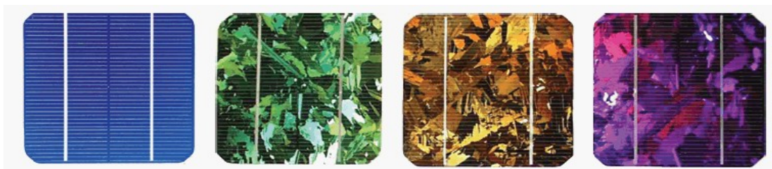
obr. 4.3 Monokrystalické a barevné multikrystalické křemíkové solární články [4]
