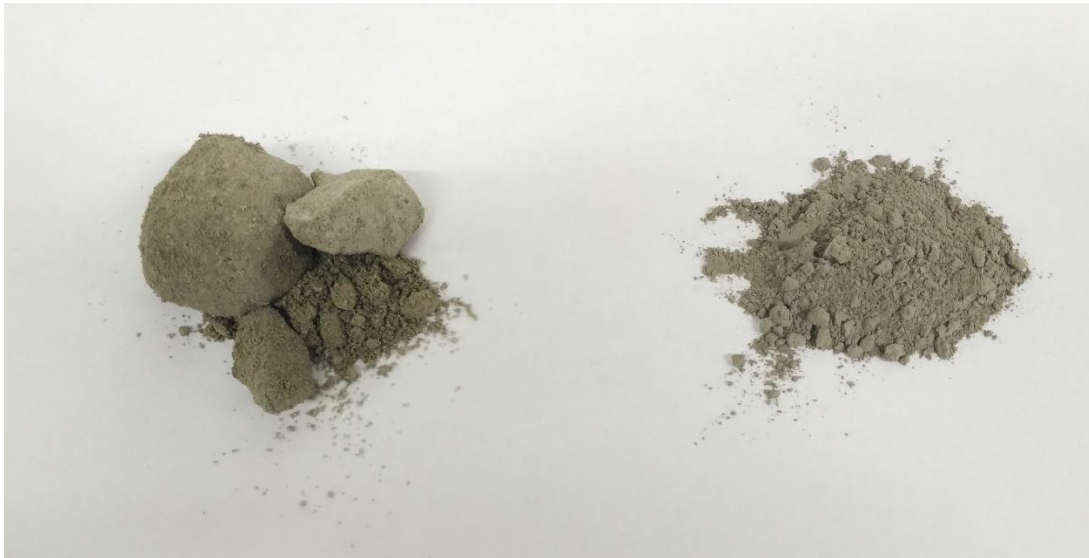
Obr. 12 Panvová troska upravená pred mletím (vľavo) a po mletí (vpravo) na vibračnom mlyne po dobu 60 min
